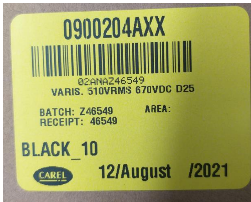
Slika 7. Izgled etikete za identifikaciju materijala
