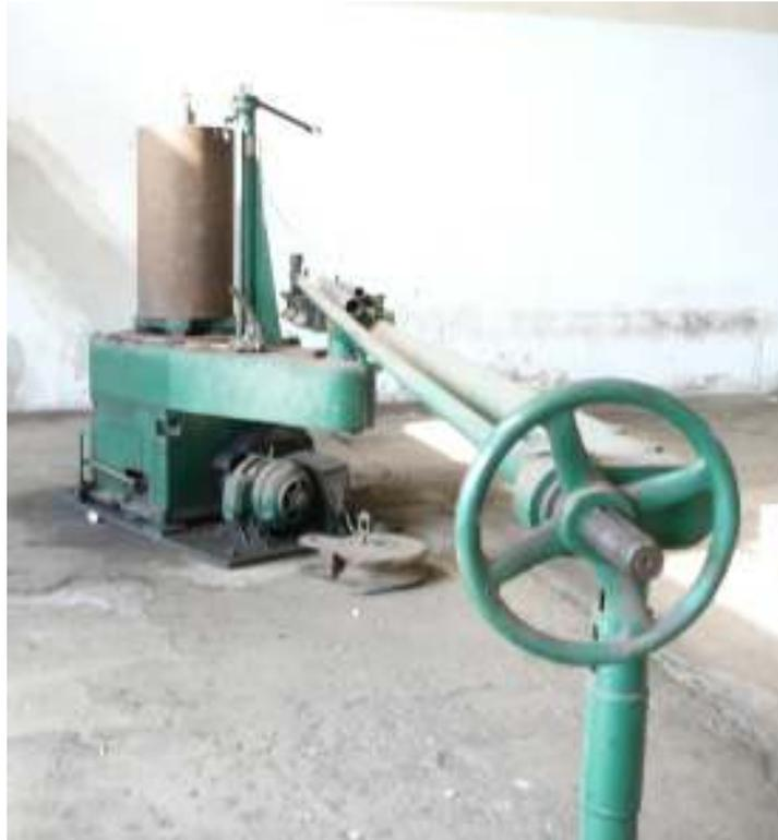
Slika 17. Savijačica cijevi-serpentina cilindrična
