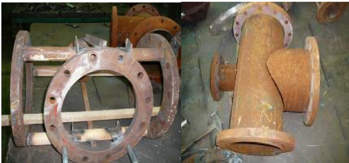
Slika 22.Šablona za izradu cijevi i slobodna cijev
