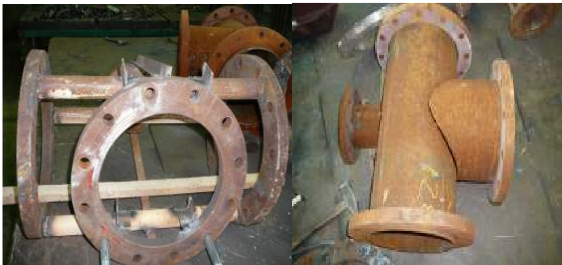
Slika 22.Šablona za izradu cijevi i slobodna cijev
