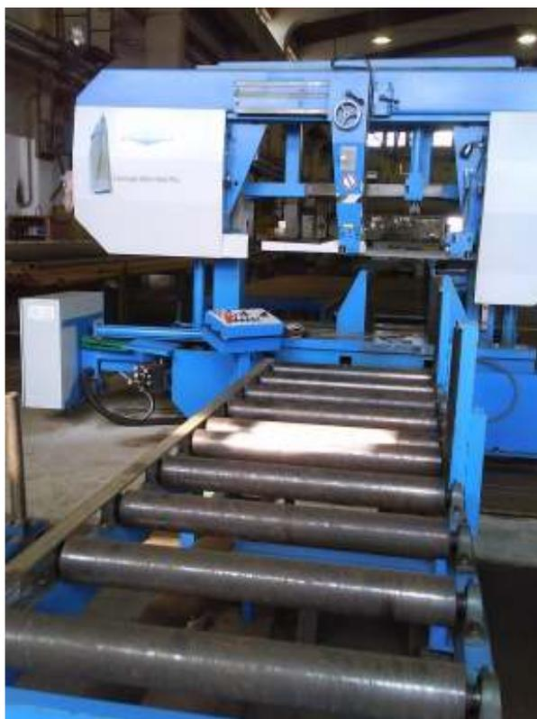
Slika 10. Tračna pila JAESPA 800/1000PG
