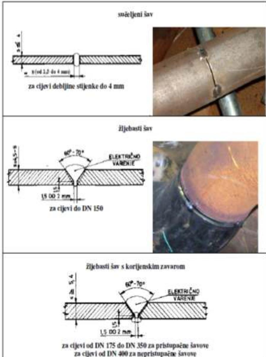
Slika 19. Vrste sučeljnih zavarenih spojeva
