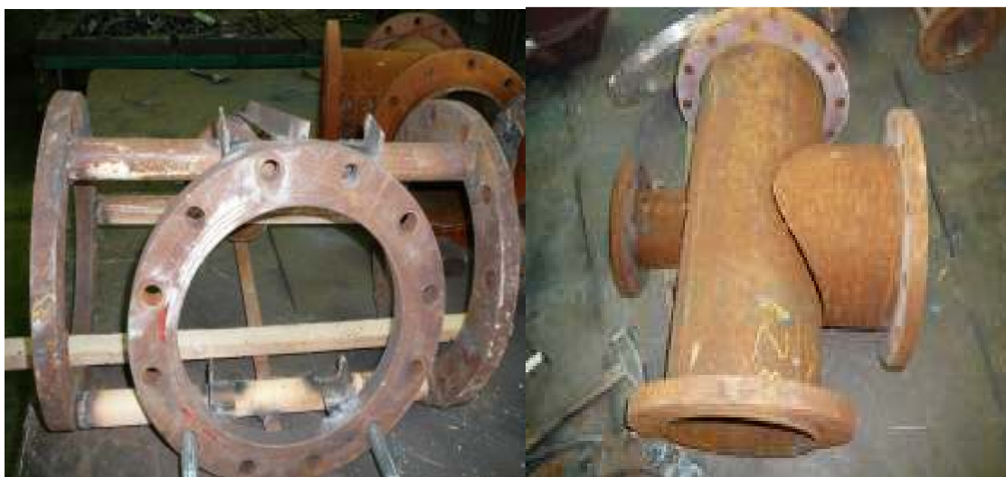
Slika 22.Šablona za izradu cijevi i slobodna cijev
