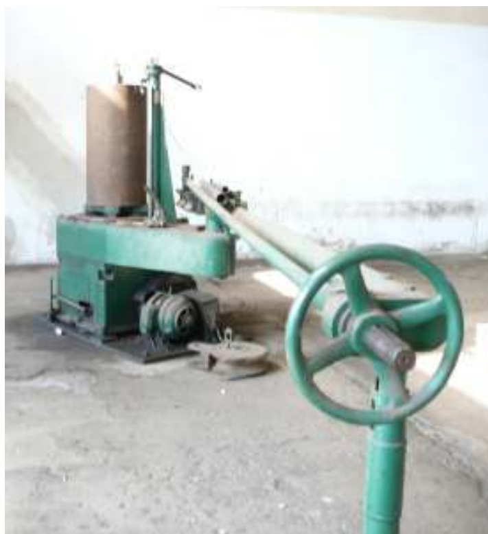
Slika 17. Savijačica cijevi-serpentina cilindrična
