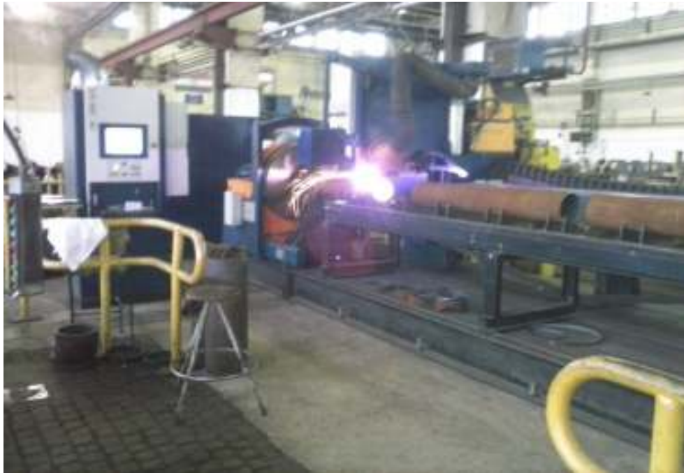
Slika 11. CNC rezačica SPC 800
