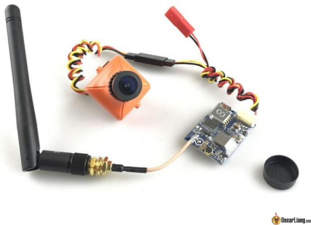
Slika 8. Prikaz VTX-video odašiljača
