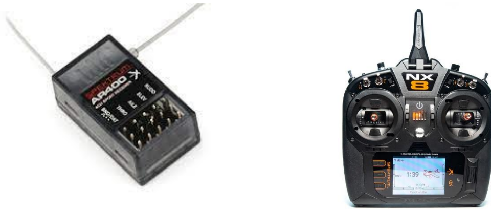
Slika 20. Radio prijemnik AR400( lijevo) Radio odašiljač Spektrum NX8
