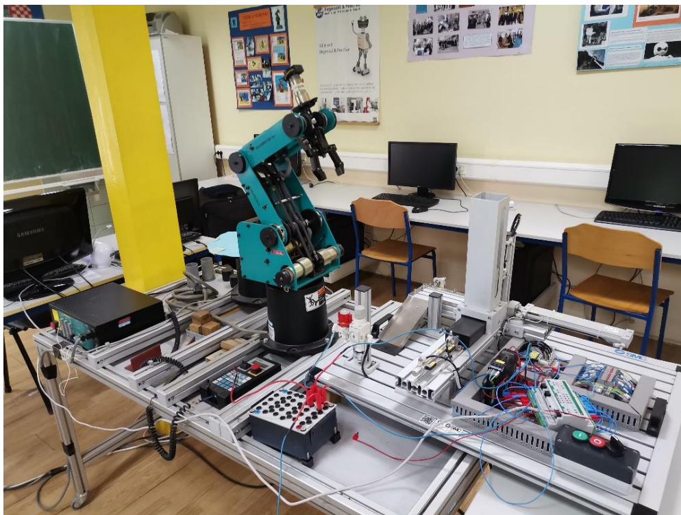
Slika 18 Prikaz sustava za automatsko sortiranje obratka i robotsko paletiziranje Izvor: Autor
