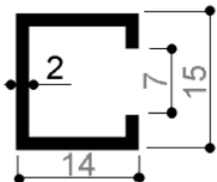
**Slika 8. Presjek aluminijskog profila za okvir svjetiljke Hyper**
