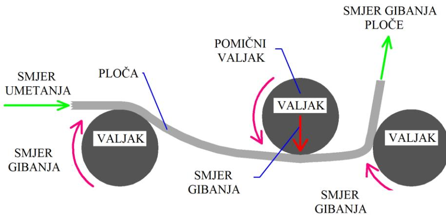
**Slika 16. Kružno savijanje**
