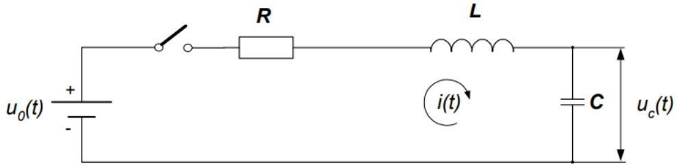
Pri rješavanju ovog sustava koristit će se Kirchoffovi zakoni, Ohmov zakon i Faradeyev zakon. Uzima se u obzir da je početni naboј 0. Padove napona na otporniku  $u_R$ , na zavojnici  $u_L$ , i na kondenzatoru  $u_C$  dobit će se iz sljedećih jednadžbi:
