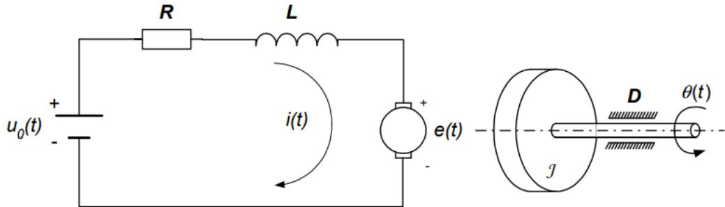
Moment motora zadan je pomoću konstante motora  $K_m$  i struje  $i$ , a napon koji se suprotstavlja  $e$  nastao gibanjem u magnetskom polju, zadan je pomoću konstante generatora  $K_g$  i kutne brzine gibanja rotora  $\alpha$ .
