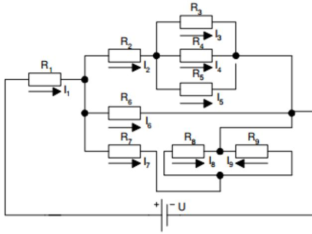
Potrebno je zbrojiti otpornike kako bi dobili jednostavniju shemu u kojoj su serijski spojene  $R_2$  i  $R_{345}$ ,  $R_7$  i  $R_{89}$ , te su međusobno paralelni spojeni s  $R_6$ .
