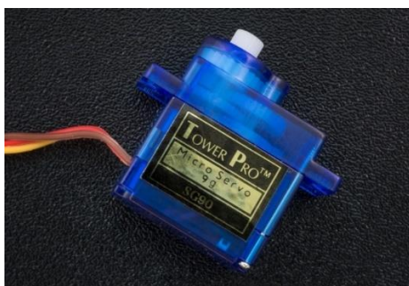
Slika 17. Servo motor TowerPro SG90
