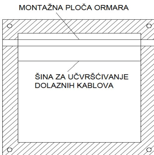
Slika 17. Tlocrt postolja eletkro ormara nacrtan u AutoCad softwareu
