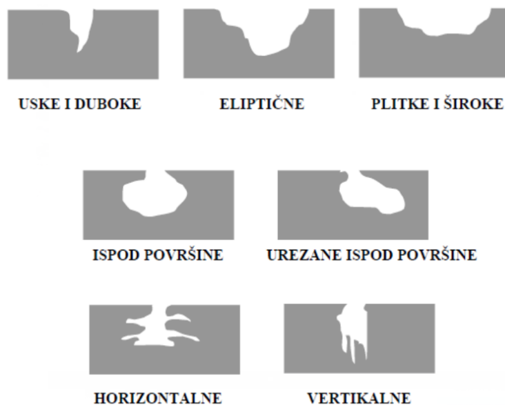
Slika 6. Vrste pitting korozije nehrđajućih čelika
