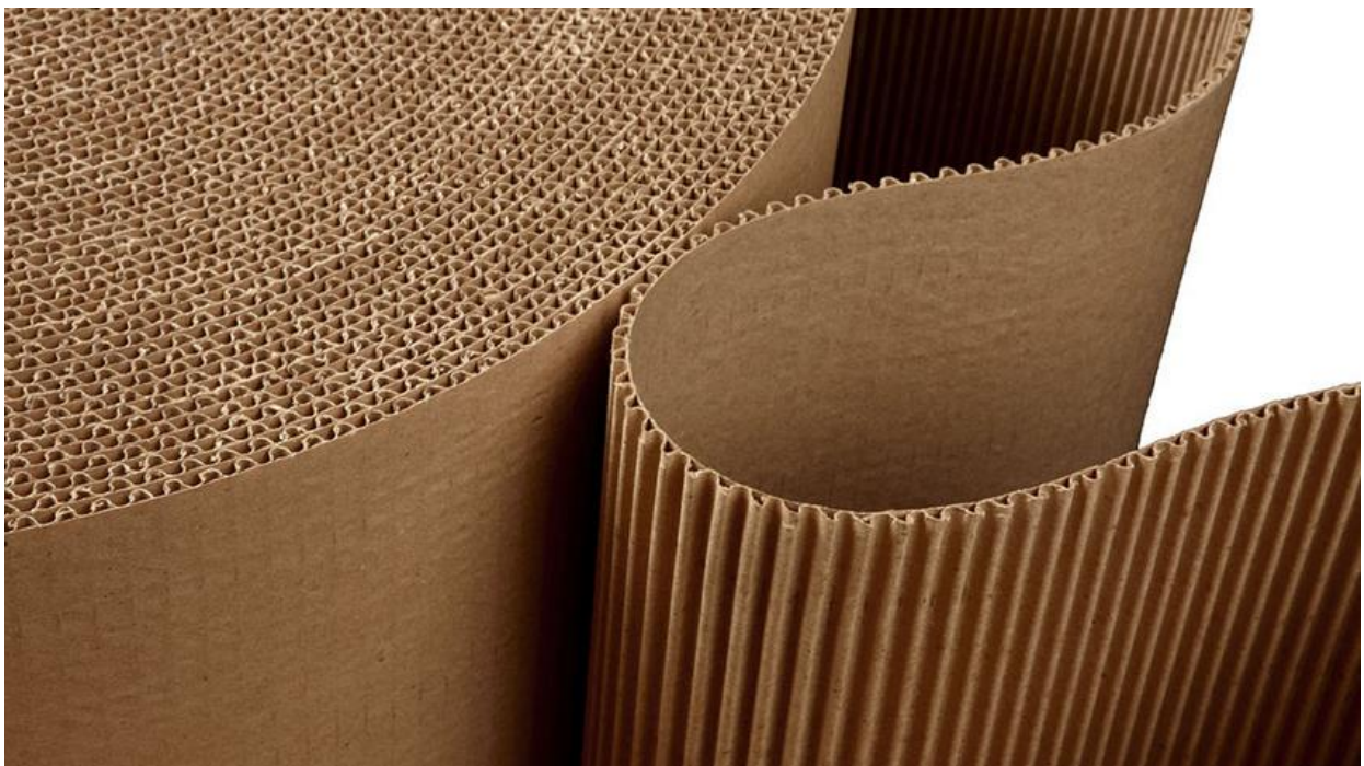
Slika 4: Dvoslojna valovita ljepenka (Izvor: www.panpak.rs/tag/9 )
