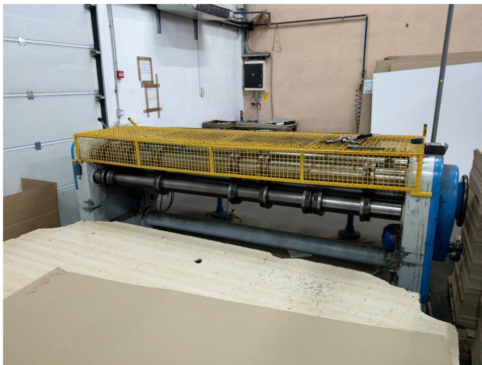
Slika 20: Kružne škare (Izvor: Autor)
