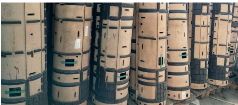
Slika 26: Roto štanca na izlazu slotera (Izvor: Autor)
