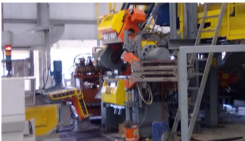
Slika 10 – Otvorena glava ekstrudera, ATCo. Egipat
