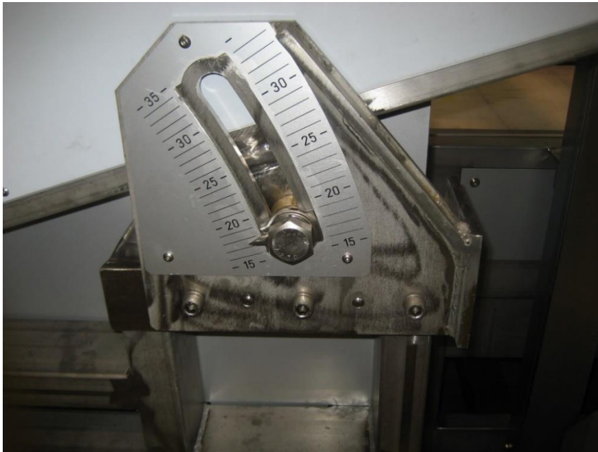
Slika 35 – Podešavanje kuta rezanja 1
