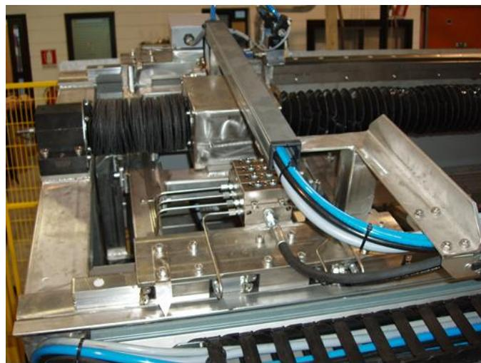
Kuglično navojno vretno i vodilice koje se automatski ne podmazuju treba tretirati po uputama proizvođača Bosch – Rexroth [12]. Isto vrijedi za reduktor Sew Eurodrive [13].
