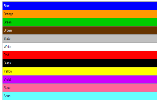
Slika 15: Kodiranje niti bojom u kabelu tvrtke Corning
