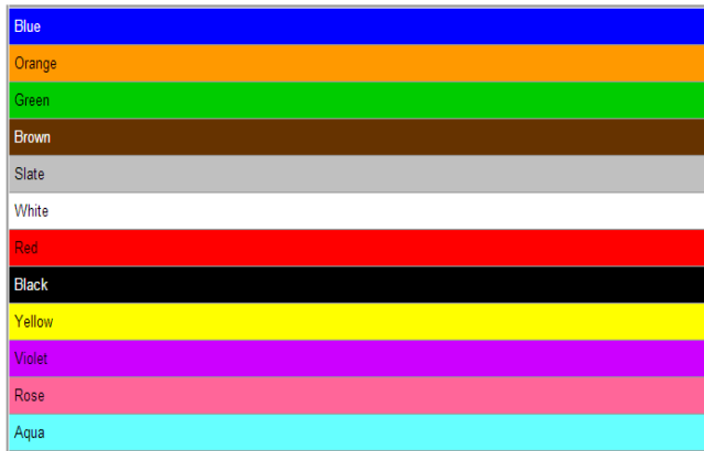
Slika 15: Kodiranje niti bojom u kabelu tvrtke Corning
