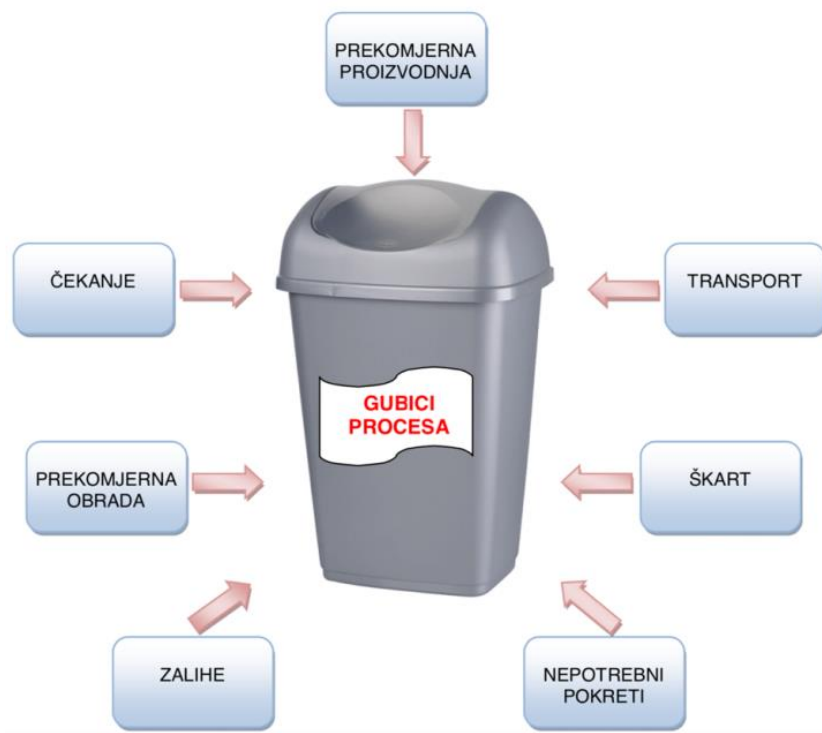
Slika 7 - Prikaz gubitaka/rasipanja u procesu proizvodnje. Izvor: 89
