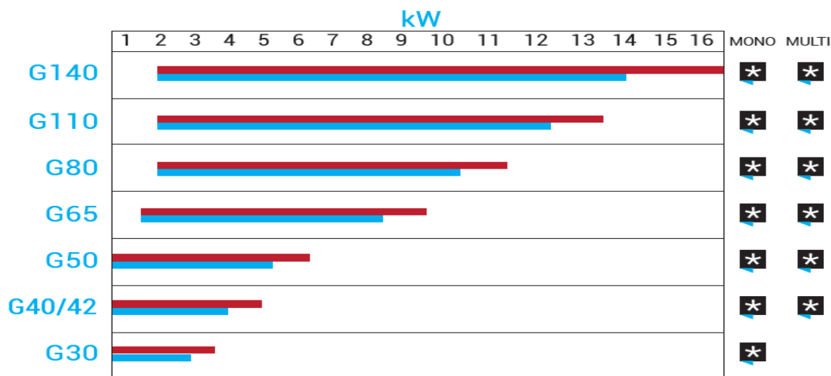
Slika 37. dijagram raspona snaga, tipova vanjskih jedinica, izvor www.technibel.com
