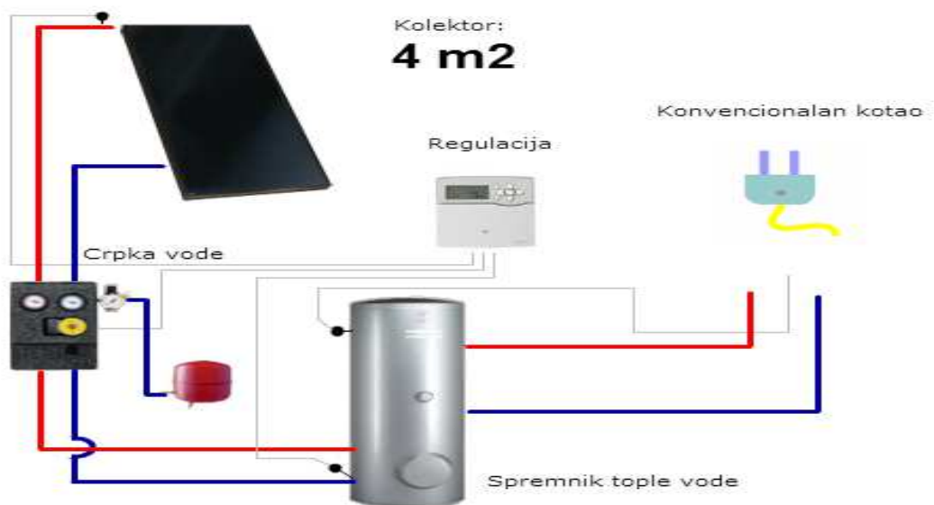
Slika 27. dimenzionirani sustav, izvor www.viessman.hr
