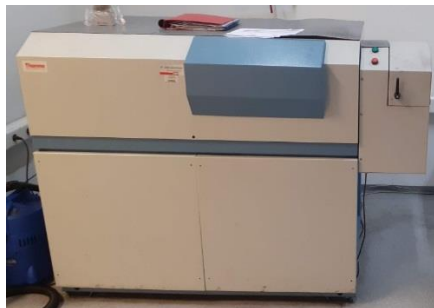
Slika 21. Spektrometar THERMO - ARL 3460 ADVANTAGE [Autor]
