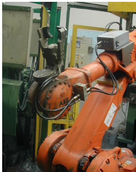
Slika 9. Robot za iznos odljevaka [3]
