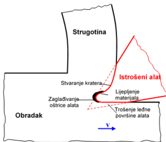
Slika 3.1 Površine trošenja alata [2]
