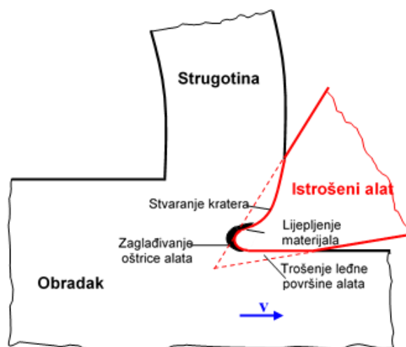
Slika 3.1 Površine trošenja alata [2]
