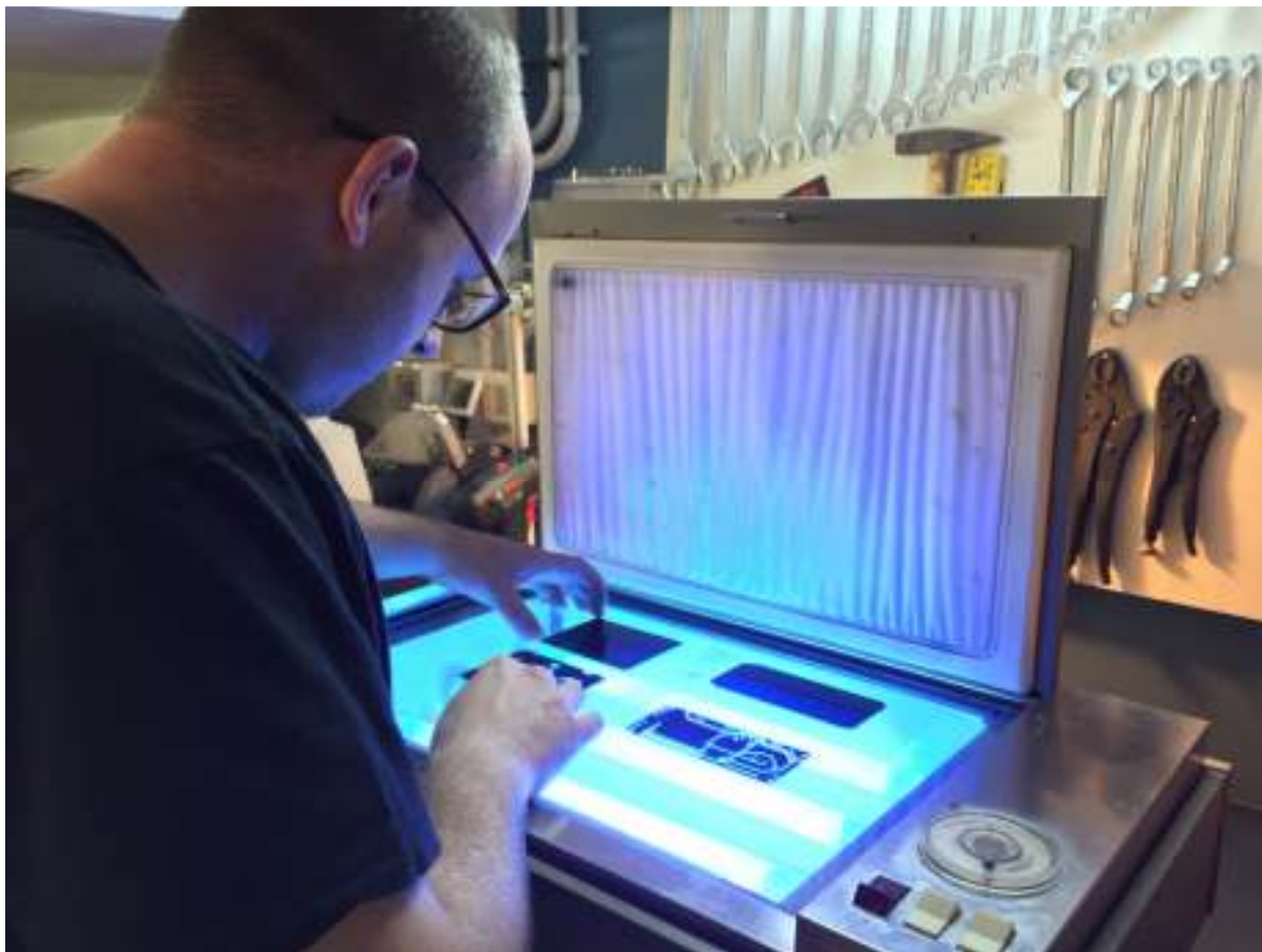
Slika 39. Postavljanje materijala i filma u uređaj za osvjetljavanje
