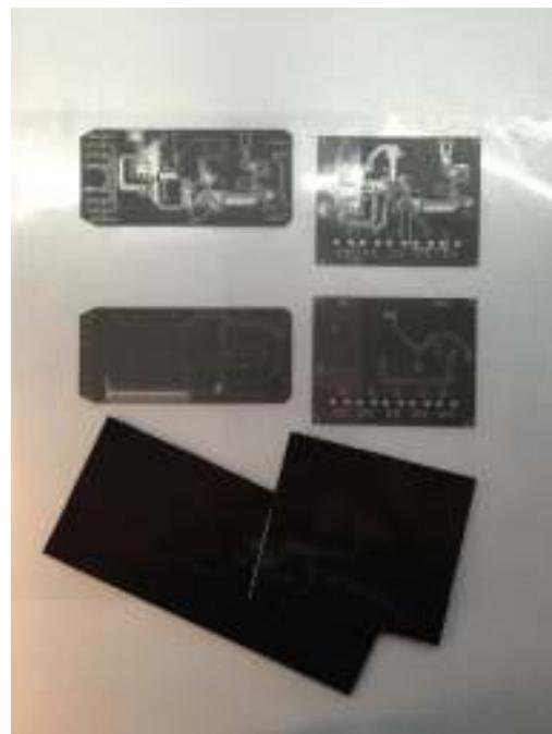
**Slika 37. Film za razvijanje tiskanih pločica i materijal za njihovu izradu**
