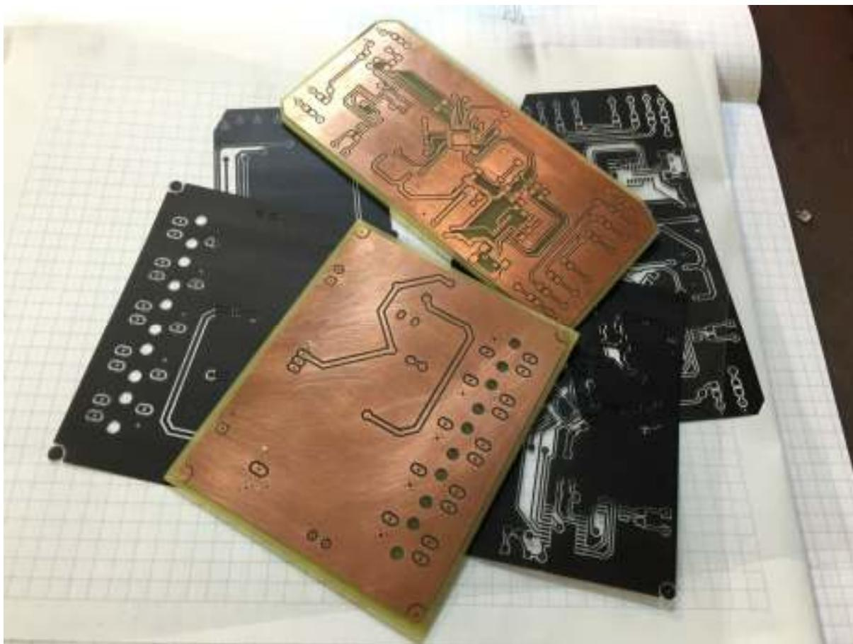
**Slika 43. Izrađene tiskane pločice oba modula**
