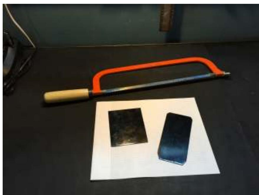
**Slika 38. Obrađeni materijal za izradu tiskanih pločica**
