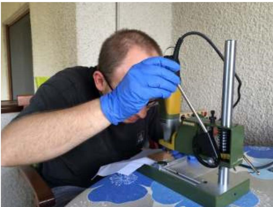
Slika 44. Bušenje rupa kroz tiskane pločice modula
