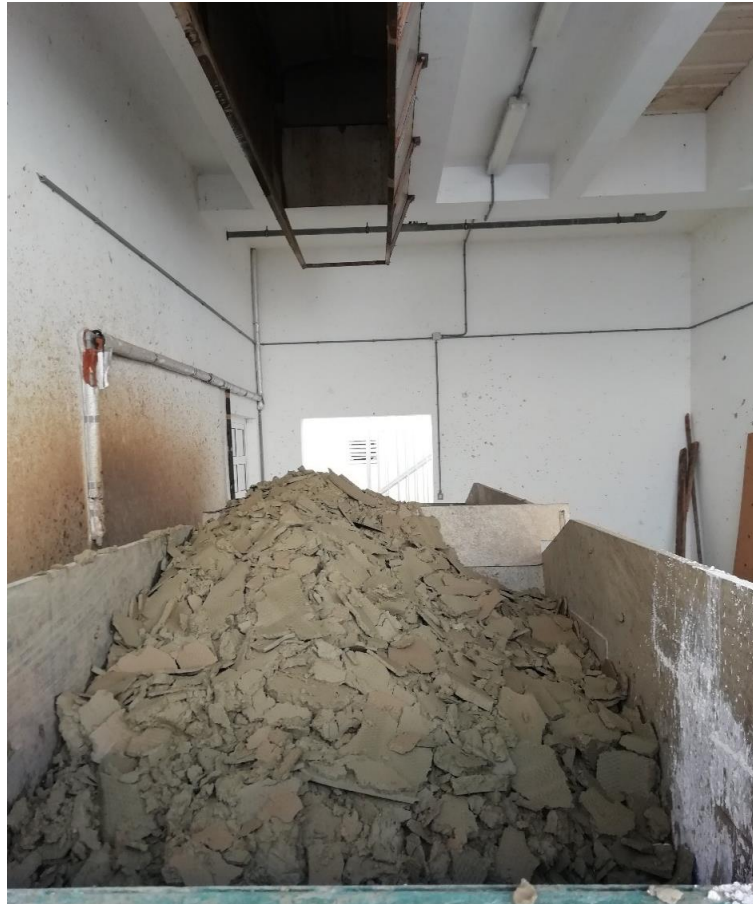
Slika 11: Filterski kolač mulja [Autor]
