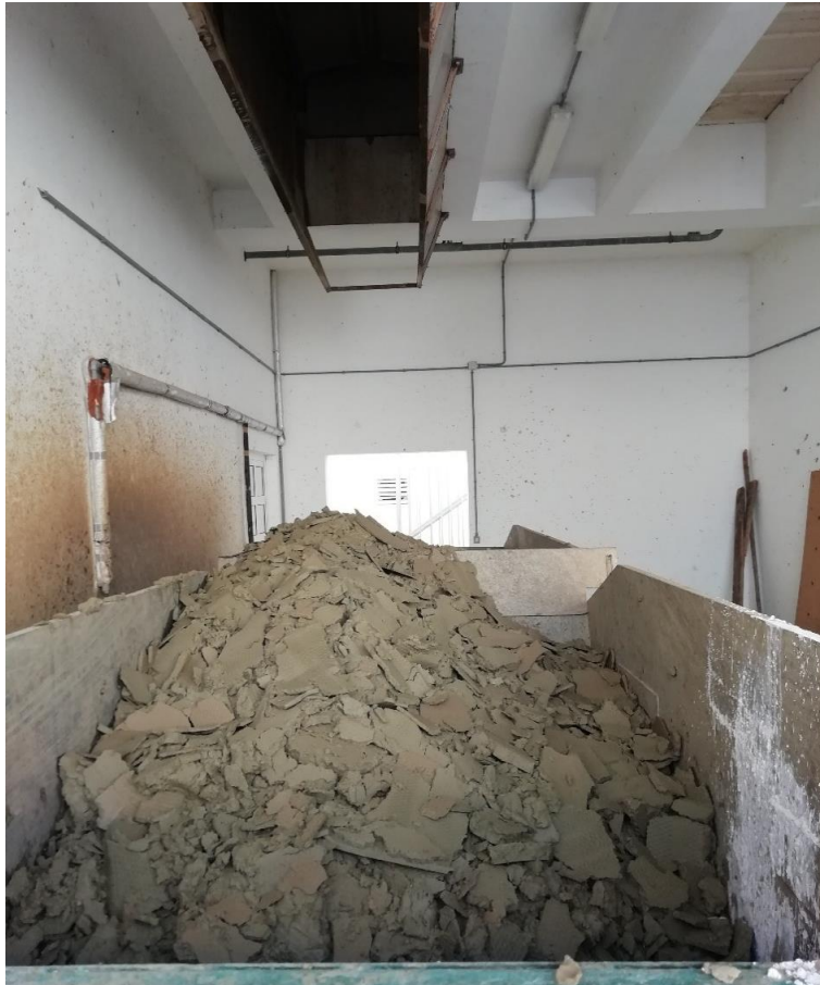
Slika 11: Filterski kolač mulja [Autor]
