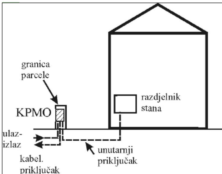
Slika 2. Niskonaponski kabelski priključak (Izvor: <http://www.riteh.uniri.hr/>)
