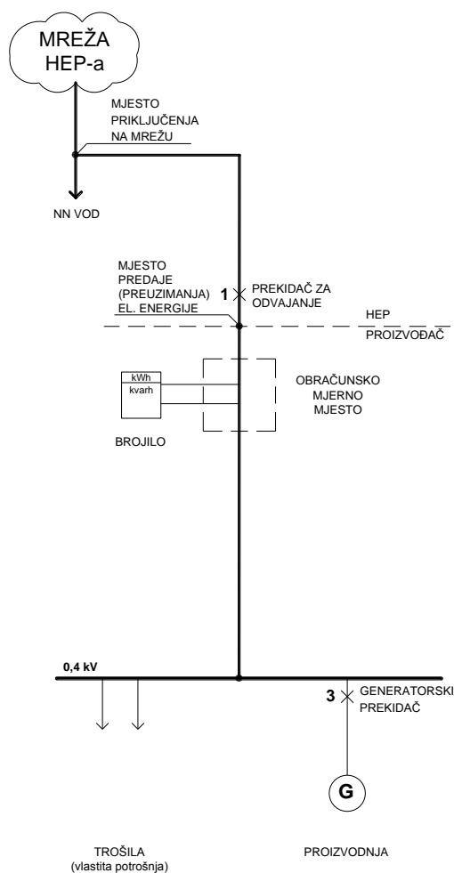
Slika 5. Priključak elektrane na NN vod (Izvor: HEP ODS d.o.o.)
