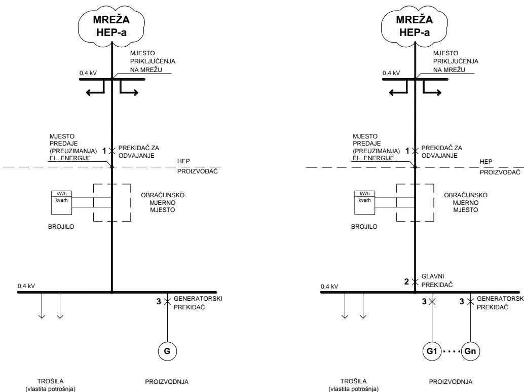
Slika 6. Priklučak elektrane na NN sabirnice u TS bez mogućnosti izoliranog pogona
