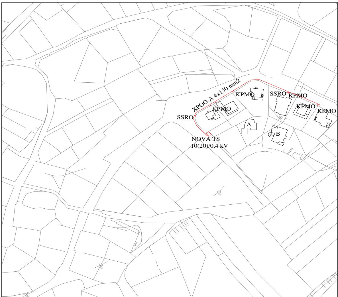
Slika 12. Priklučenje građevine kupca na niskonaponsku mrežu kada je za priključenje potrebno ostvariti tehničke uvjete u mreži izgradnjom TS 10(20)/0,4 kV (Izradio: Autor)
