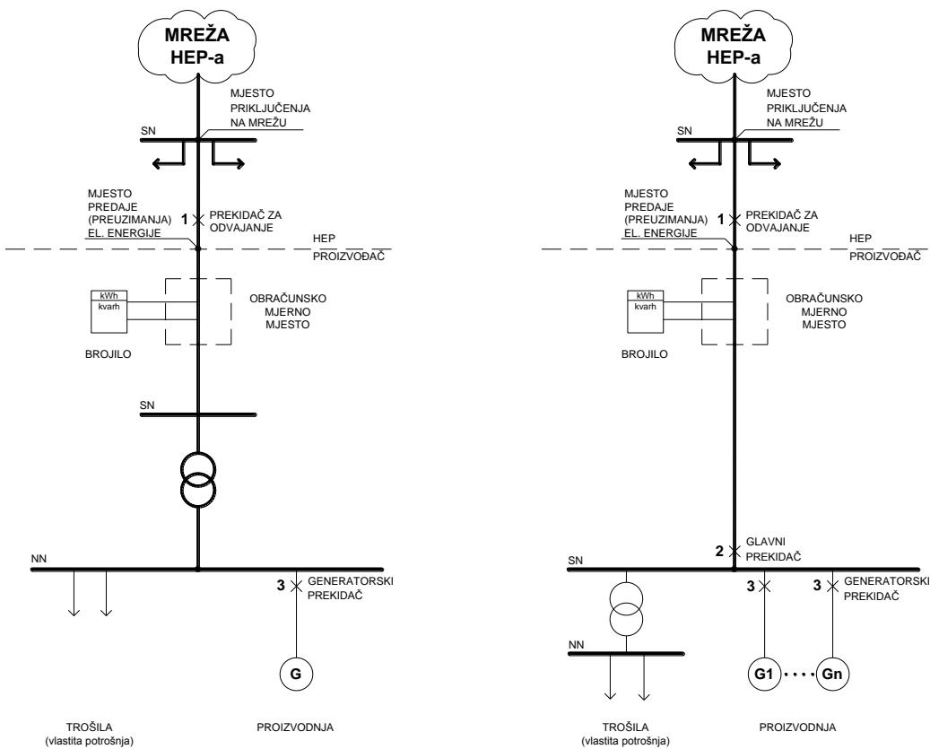
Slika 8. Priključak elektrane na SN sabirnice u TS bez mogućnosti izoliranog pogona
