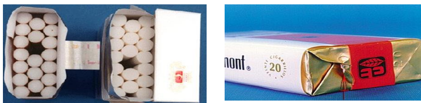
Slika 9. Primjer A (lijevo) i B (desno) greške kutijice
