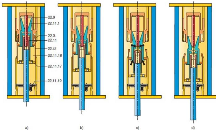
Slika 11. Princip gašenja luka te glavni dijelovi SF<sub>6</sub> prekidača. (Izvor: K. Meštrović, Sklopni aparati srednjeg i visokog napona, Graphis, Zagreb, str. 66, 2006.)
