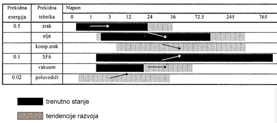
Slika 2. Korištenje osnovnih medija za gašenje električnog luka. (Izvor: K. Meštirović, Sklopni aparati srednjeg i visokog napona, Graphis, Zagreb,str.19, 2006.)
