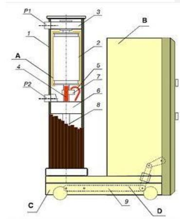
Slika 12. Vakuumski prekidač te njegovi glavni dijelovi. (Izvor: K. Meštrović, Sklopni aparati srednjeg i visokog napona, Graphis, Zagreb, str. 72, 2006.)
