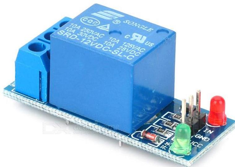
**Slika 11:** Arduino relejni modul
