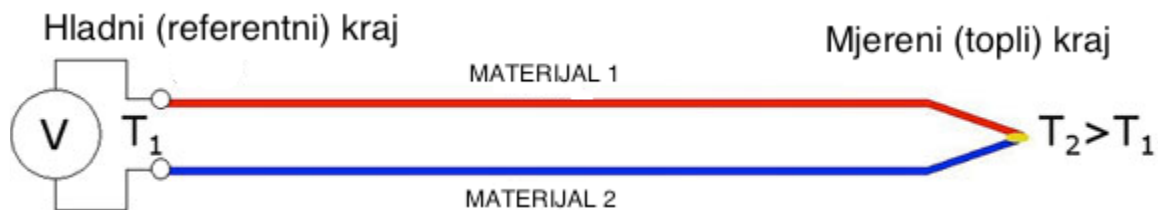
Slika 17: Princip rada termopara [5]
