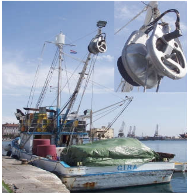
Slika 11. Puratićevo vitlo na ribarici „Gira“
