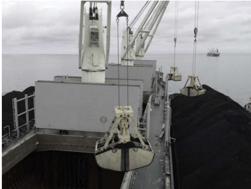
Slika 9. Prikaz grabilica za rasuti teret
