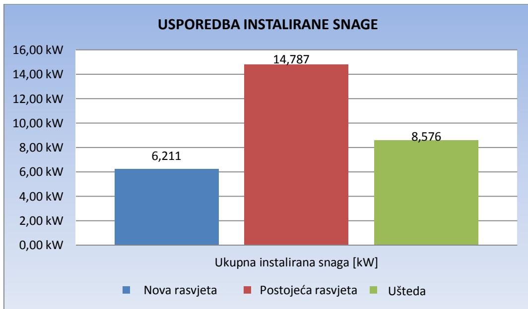
Grafikon 7 Usporedba ukupne instalirane snage (izradio: autor)
