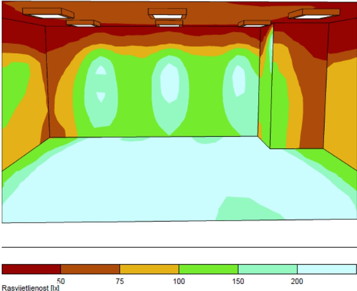
Slika 20 3D model prostorije sa prikazom rasvijetljenosti (izradio: autor)
