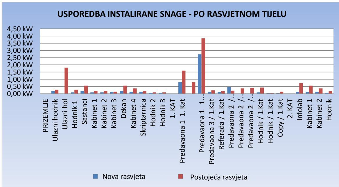
Grafikon 6 Prikaz usporedbe instalirane snage - po rasvjjetnom tijelu (izradio: autor)
