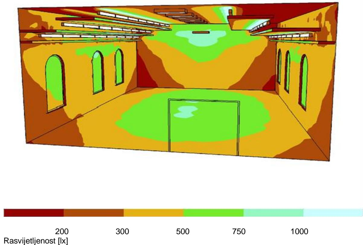
**Slika 16 3D model prostorije sa prikazom rasvijetljenosti (izradio: autor)**
