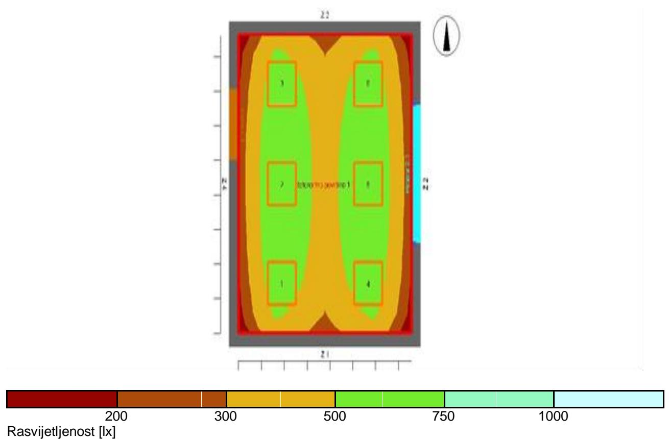
**Slika 17 Tlocrt prostorije sa prikazom jačine rasvijetljenosti (izradio: autor)**
