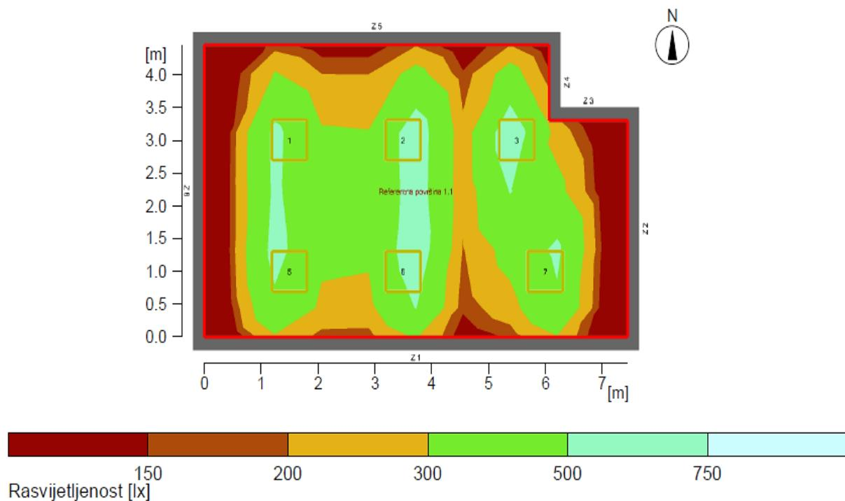
Slika 19 Tlocrt prostorije sa prikazom jačine rasvjetljjenosti (izradio: autor)
