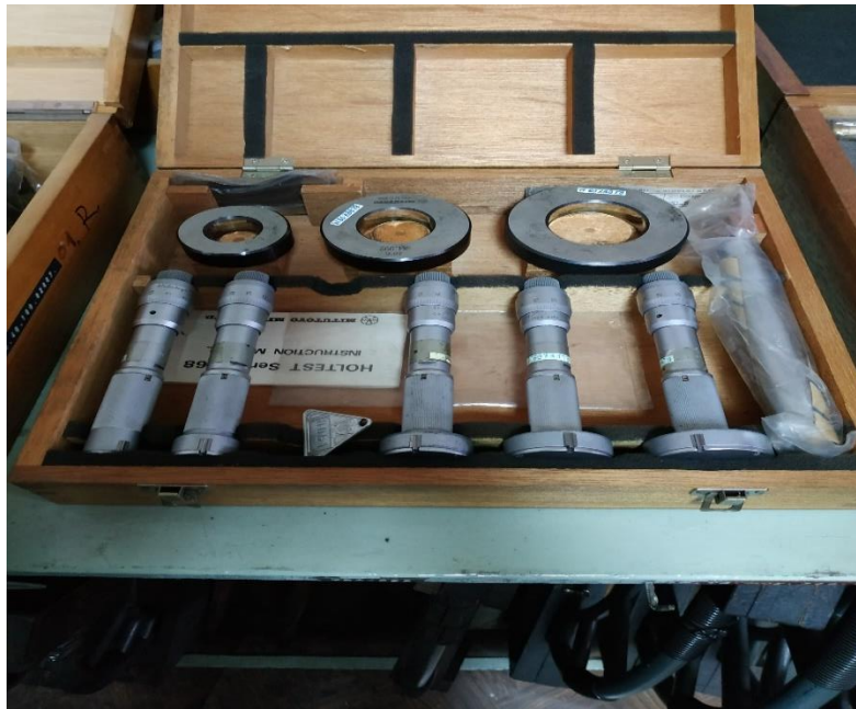
Slika 34. Mikrometar za provrte s kontrolnim prstenovima 43
