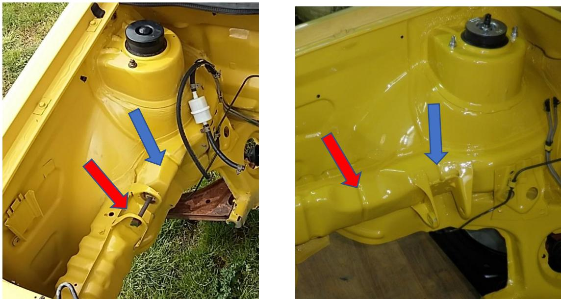
Slika 10., 11. Položaj desnog nosača motora<sup>12</sup>
