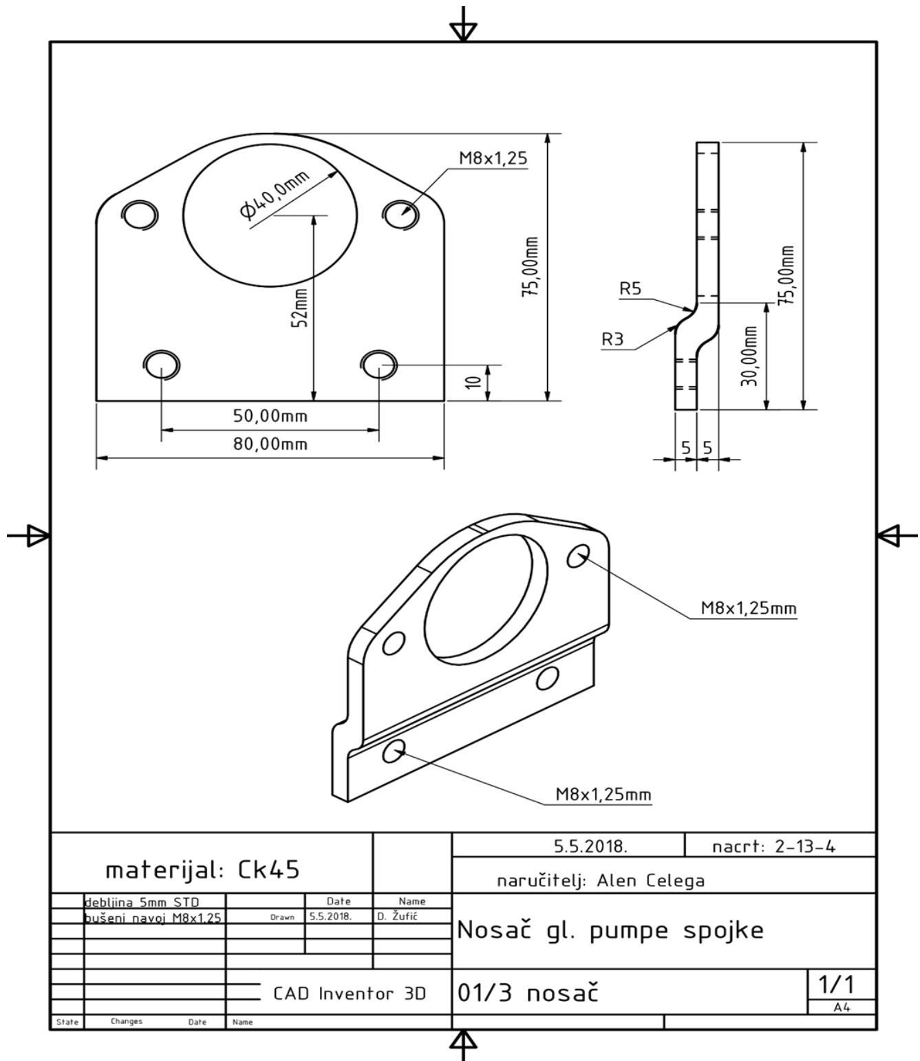
Slika 8. Nacrt nosača gl. pumpe spojke<sup>10</sup>
