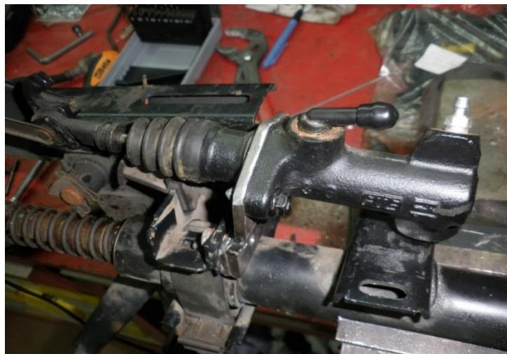
Slika 7. Glavni cilindar kvačila<sup>9</sup>
