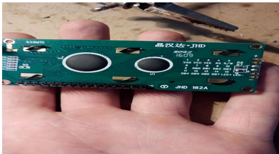
Slika 27: LCD zaslon – stražnja strana [Izvor: Izradio autor]
