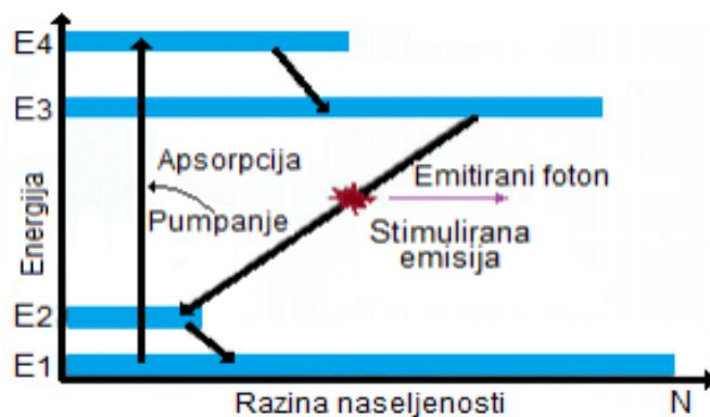
*Slika 9. Prikaz lasera s četiri energetske razine<sup>17</sup>*
