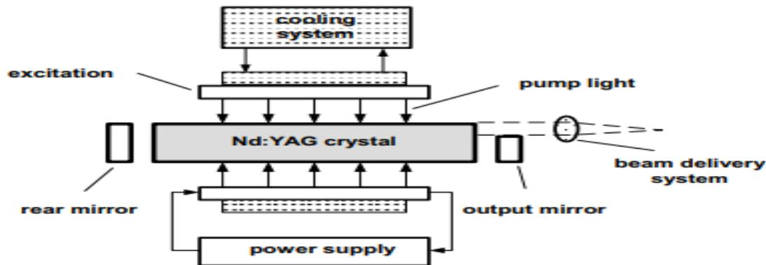
Slika 12. Shematski prikaz Nd: YAG lasera<sup>23</sup>
