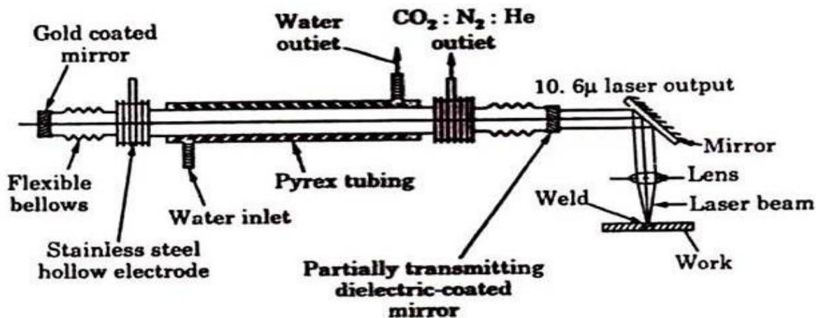
Slika 10. Shematski prikaz CO<sub>2</sub> lasera<sup>19</sup>
