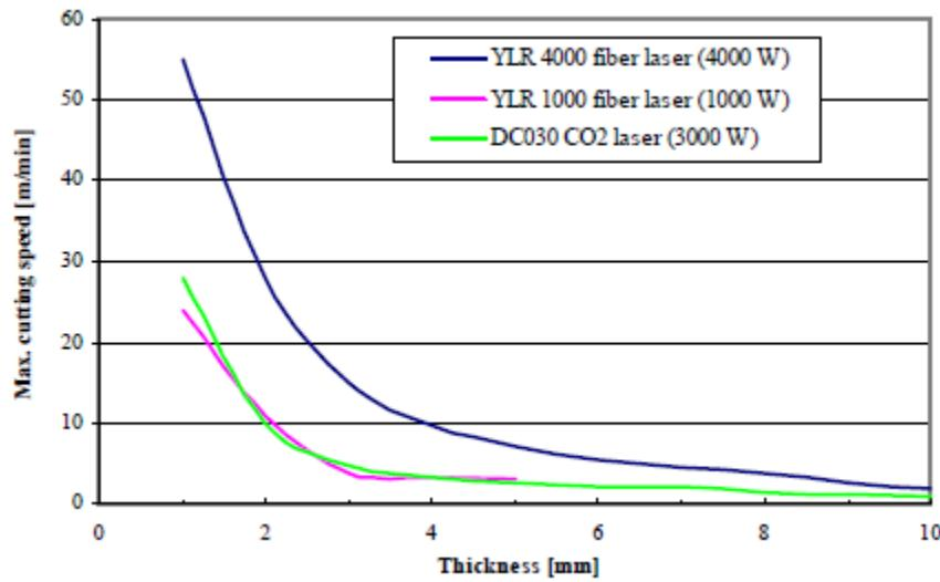
Slika 20. Usporedba različite brzine rezanja fiber i CO<sub>2</sub> lasera<sup>37</sup>
