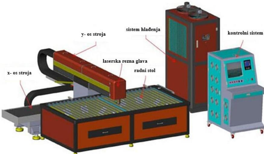
*Slika 15. CNC obradni centar s laserskom glavom<sup>27</sup>*
