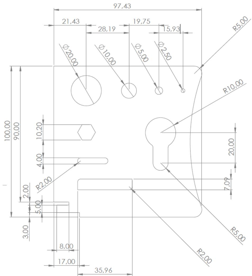
Slika 18. Nacrt uzorka za rezanje<sup>35</sup>
