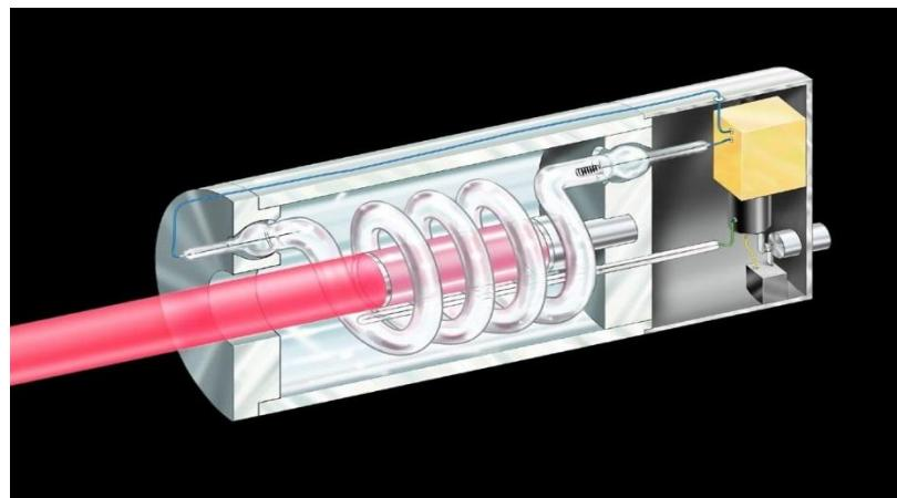
Slika 2. Prvi proizvedeni laser<sup>4</sup>
