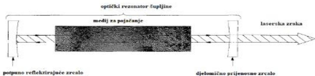
Slika 1. Pojednostavljena shema lasera<sup>1</sup>
