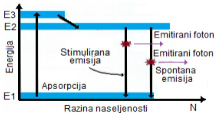
Slika 8. Prikaz lasera s tri energetske razine<sup>15</sup>
