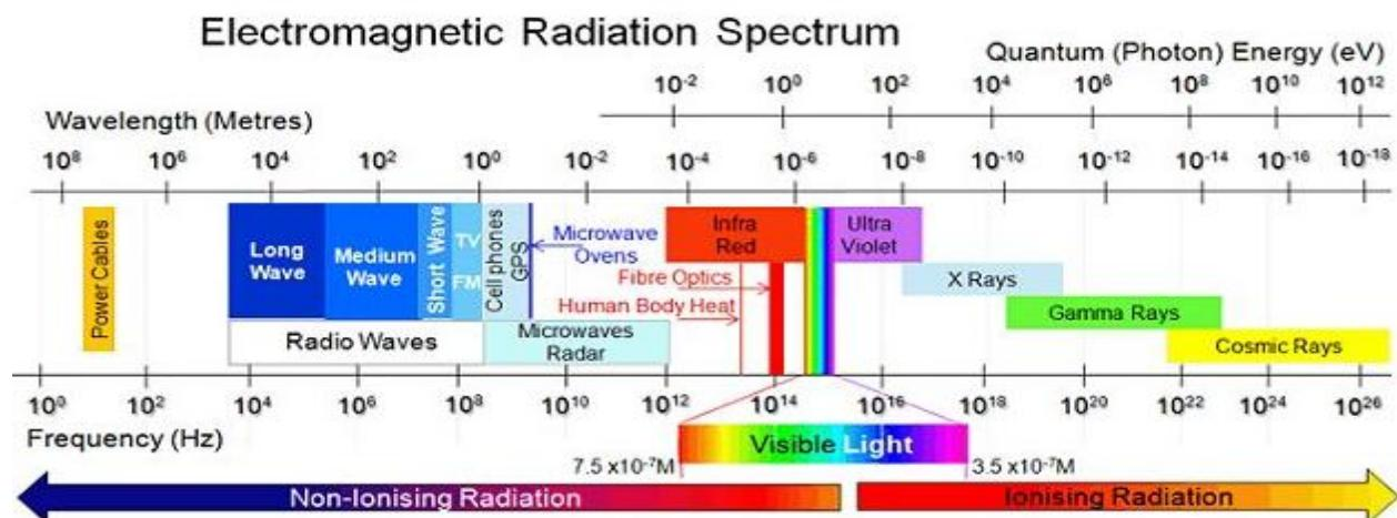
Slika 4. Spektar elektromagnetskog zračenja<sup>9</sup>
