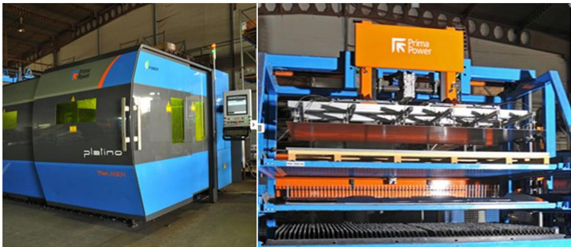
Slika 16. Obradni centar "Platino Fiber" s automatskim punjačem limova<sup>33</sup>
