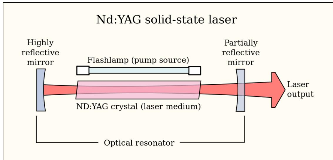
*Slika 3. Osnovni dijelovi lasera<sup>5</sup>*
