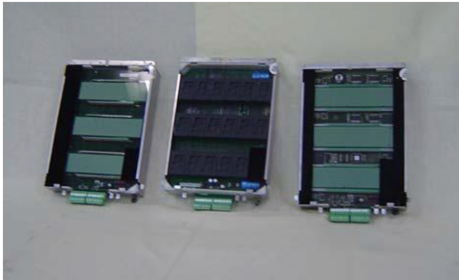
Slika 12: Pokazni uređaji LCD, FP, LED (prednji pogled), Izvor: 28
