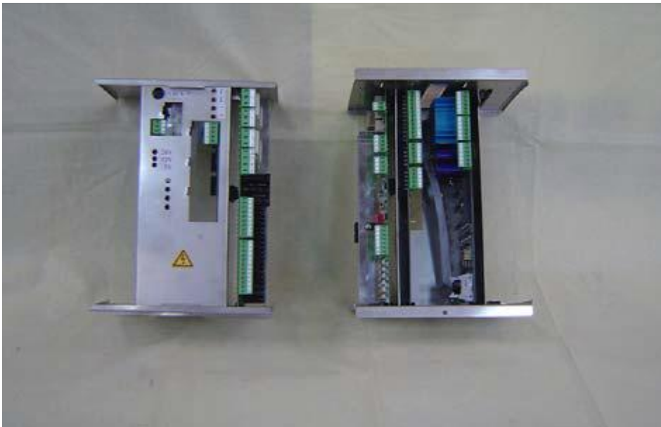
Slika 11: Elektroničko brojilo T20, Izvor: 25
