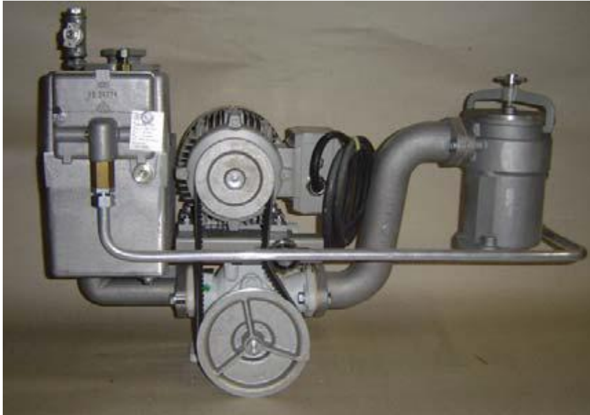
Slika 8: Sklop filtera, pumpe i separatora 9 lit, Izvor: 18
