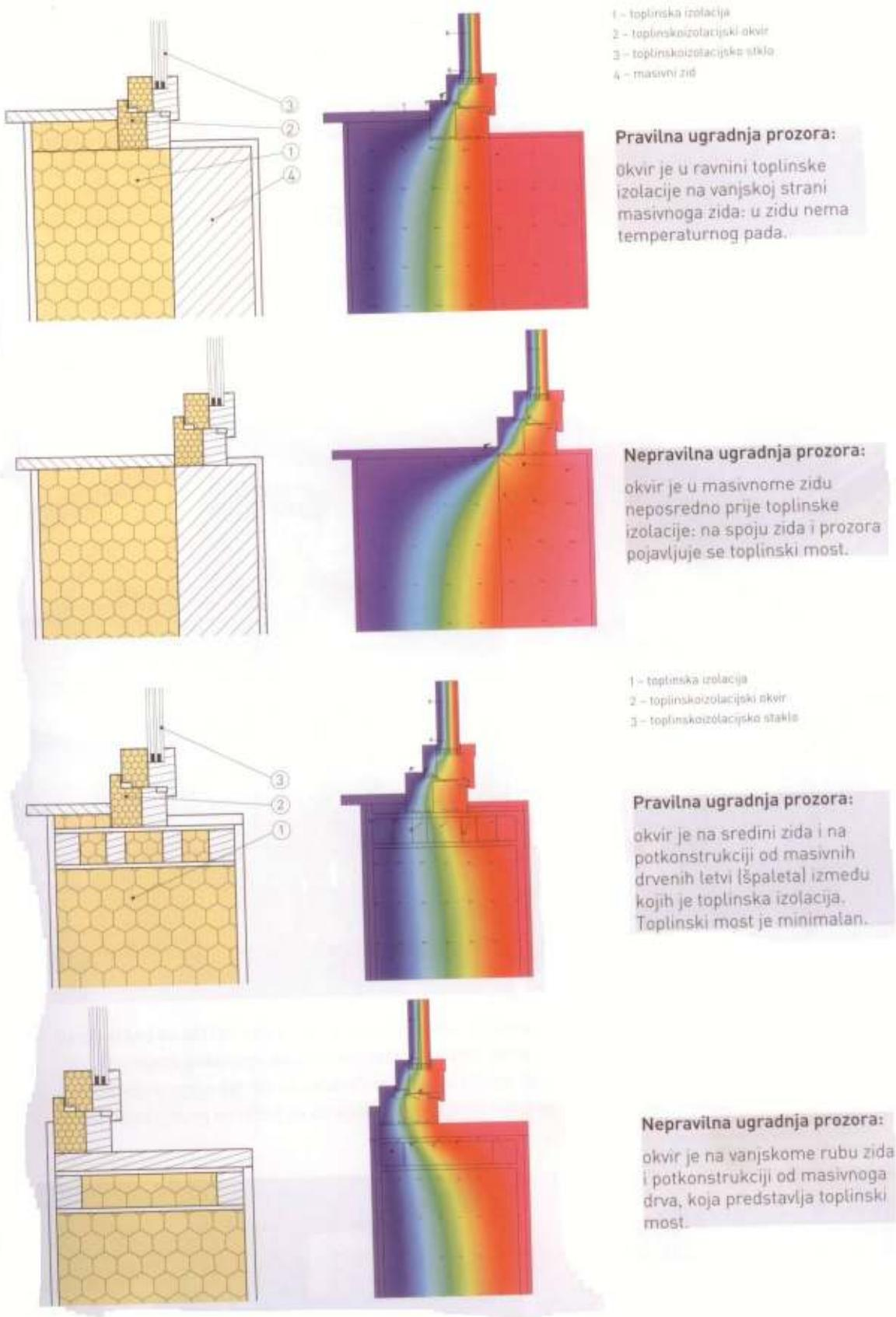
Slika 16. Ugradnja prozora u zid
