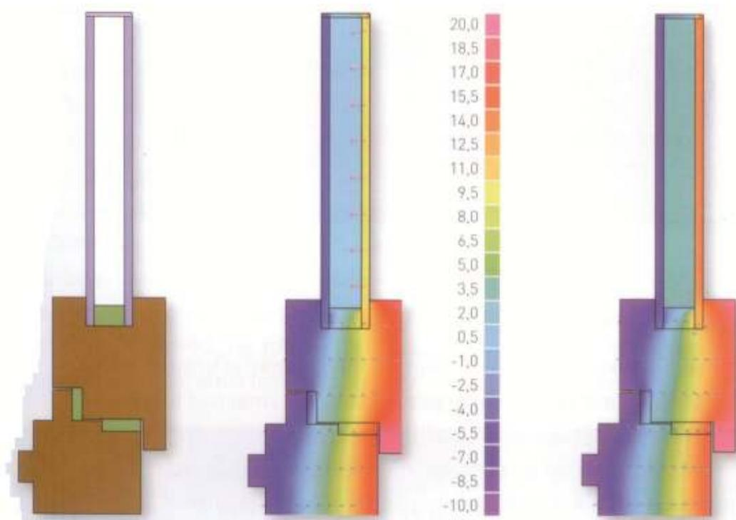
Slika 14. Temperaturni profil poprečnog presjeka dvostruko ostakljenog prozora
