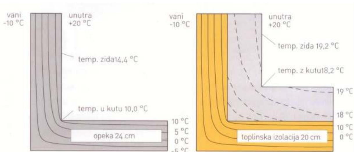
Slika 7. Usporedba temperature na unutarnjoj površini kod izoliranog i neizoliranog zida
