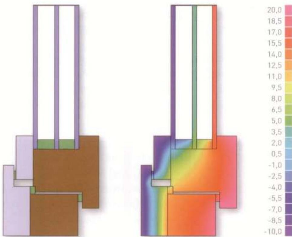
**Slika 15. Temperaturni profil poprečnog presjeka trostruko ostakljenog prozora**
