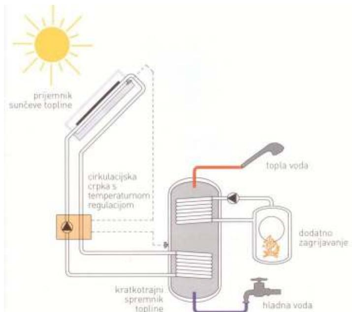
Slika 29. Shema sunčanog sustava za grijanje sanitarne vode
