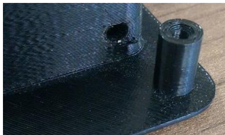
Slika 26. Izrada provrta kod FDM postupka
