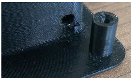
Slika 26. Izrada provrta kod FDM postupka
