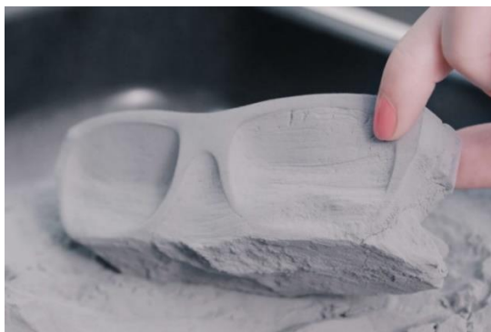
Slika 11. Uklanjanje praha koji se nije očvrstnuo
