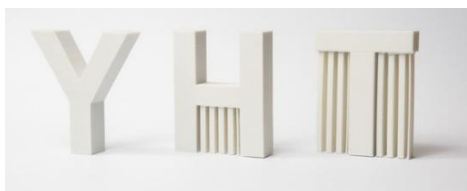
Slika 25. Potporna struktura kod FDM postupka
