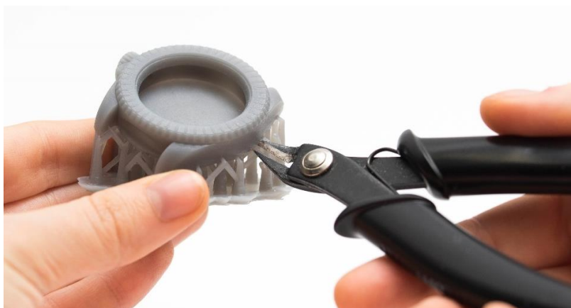
Slika 7. Uklanjanje potporne strukture
