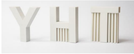
Slika 25. Potporna struktura kod FDM postupka
