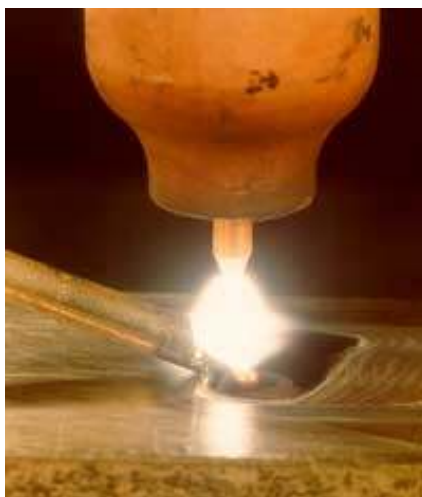
Slika 2.4.2.: Prikaz zavarivanja materijala TIG postupkom [7]
