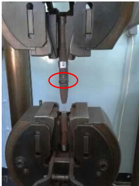
Slika 6.12.: Puknuće ispitnog uzorka A (gore) i uzorka B (dolje) [13]
