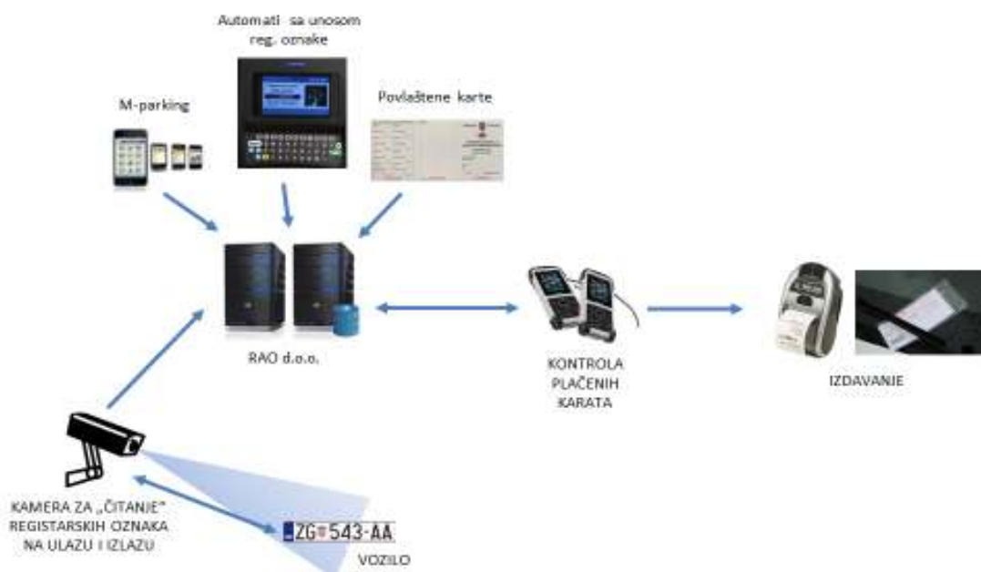
Slika 17: Shema sustava za automatsko čitanje registarskih oznaka
