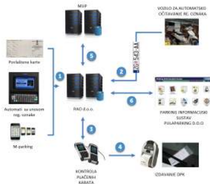
Slika 16: Shema sustava za automatsko čitanje registarskih oznaka i kontrolu plaćanja usluge parkiranja Izvor: izrada autora
