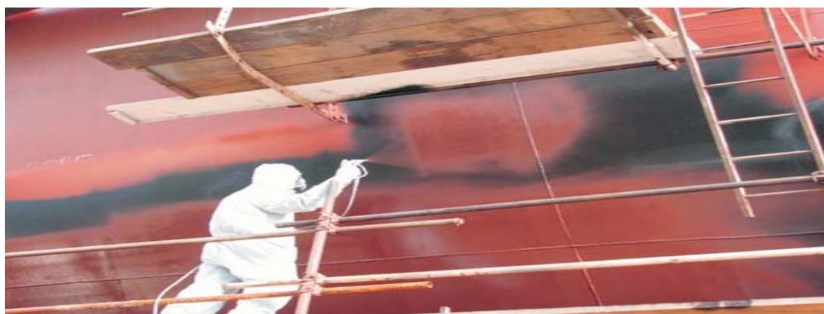
Slika 16: Nanošenje premaza špricanjem u Brodogradilištu Uljanik
