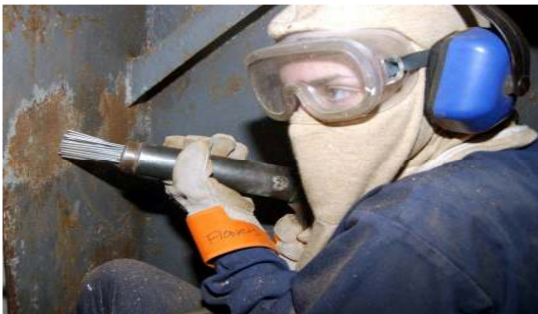
Slika 15: Uklanjanje korozivnih produkata na brodu
