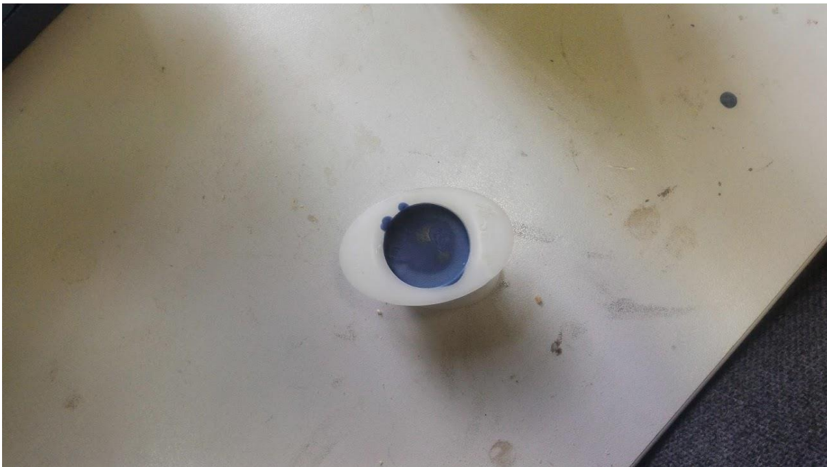
Slika 16. Kalup s polimernom smolom i čelikom
