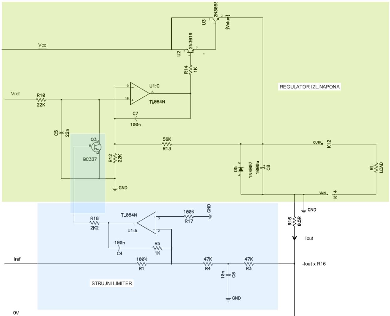
Slika 15: Operacijsko pojačalo u sklopu regulatora napona i strujnog limitatora
