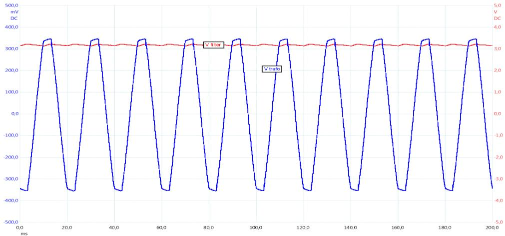
**Slika 27:** Valni oblici na sekundaru transformatora i na izlazu iz Graetza
