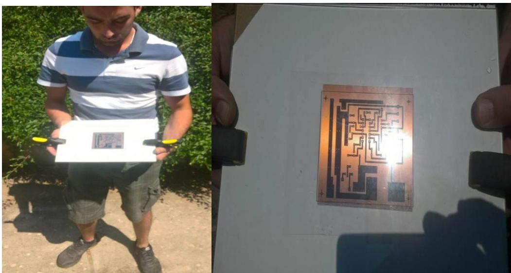
**Slika 18:** Osvjetljavanje pločice na suncu
