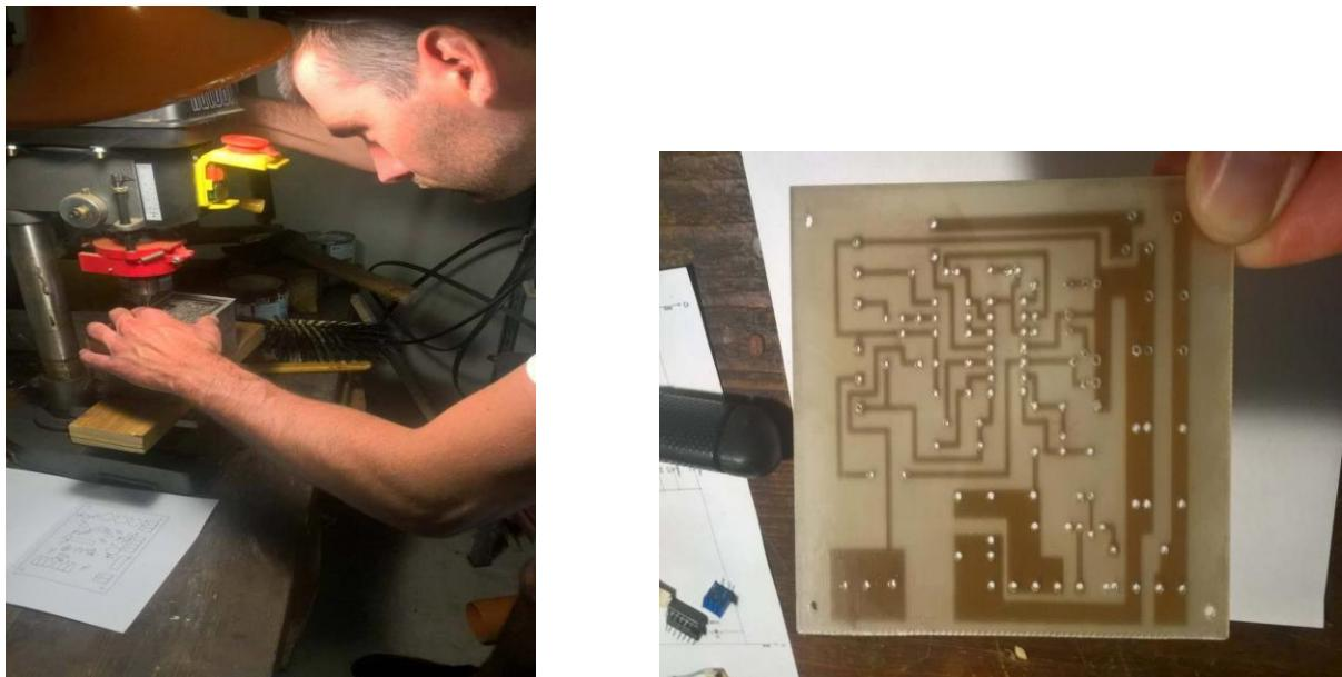
**Slika 23:** Bušenje i rezultat bušenja
