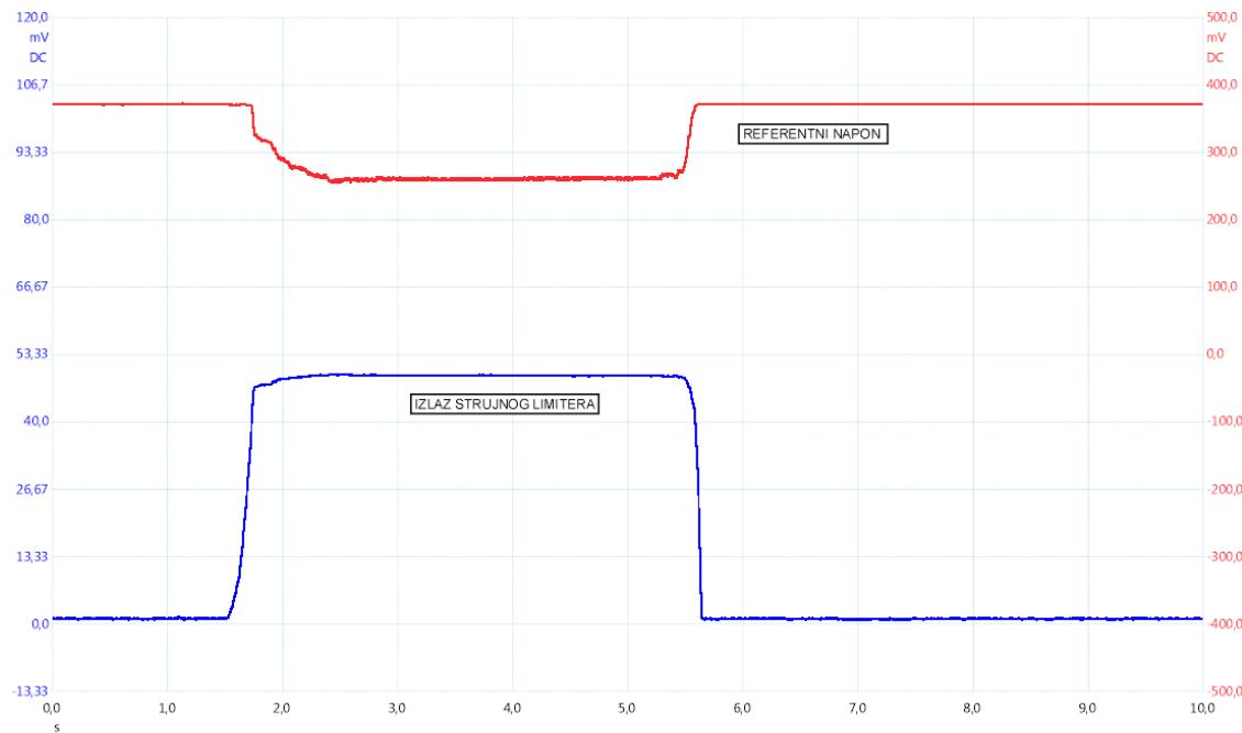
**Slika 30:** Karakteristika strujnog limitatora
