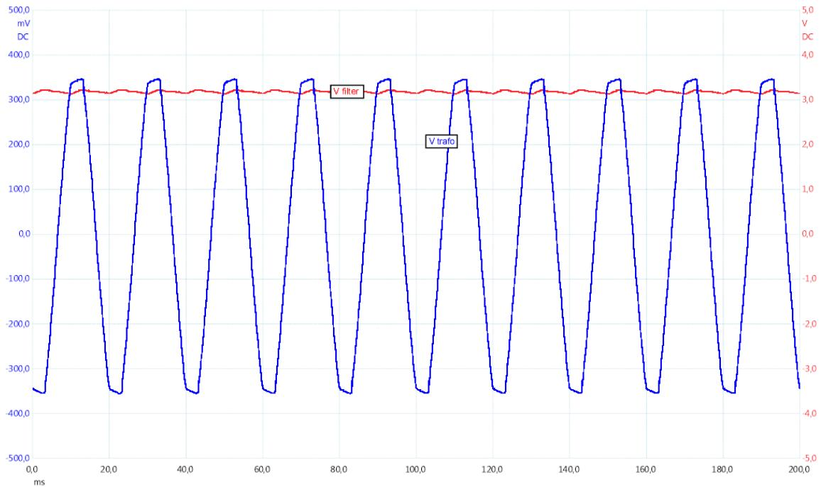
**Slika 5:** Ulagano-izlazna karakteristika filtriranog napona Graetzovog mosta mjereno osciloskopom
