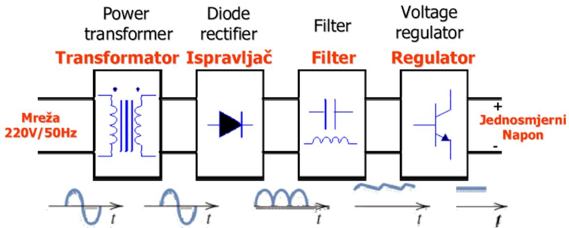
**Slika 1:** Blok shema linearnom reguliranom izvoru napajanja
