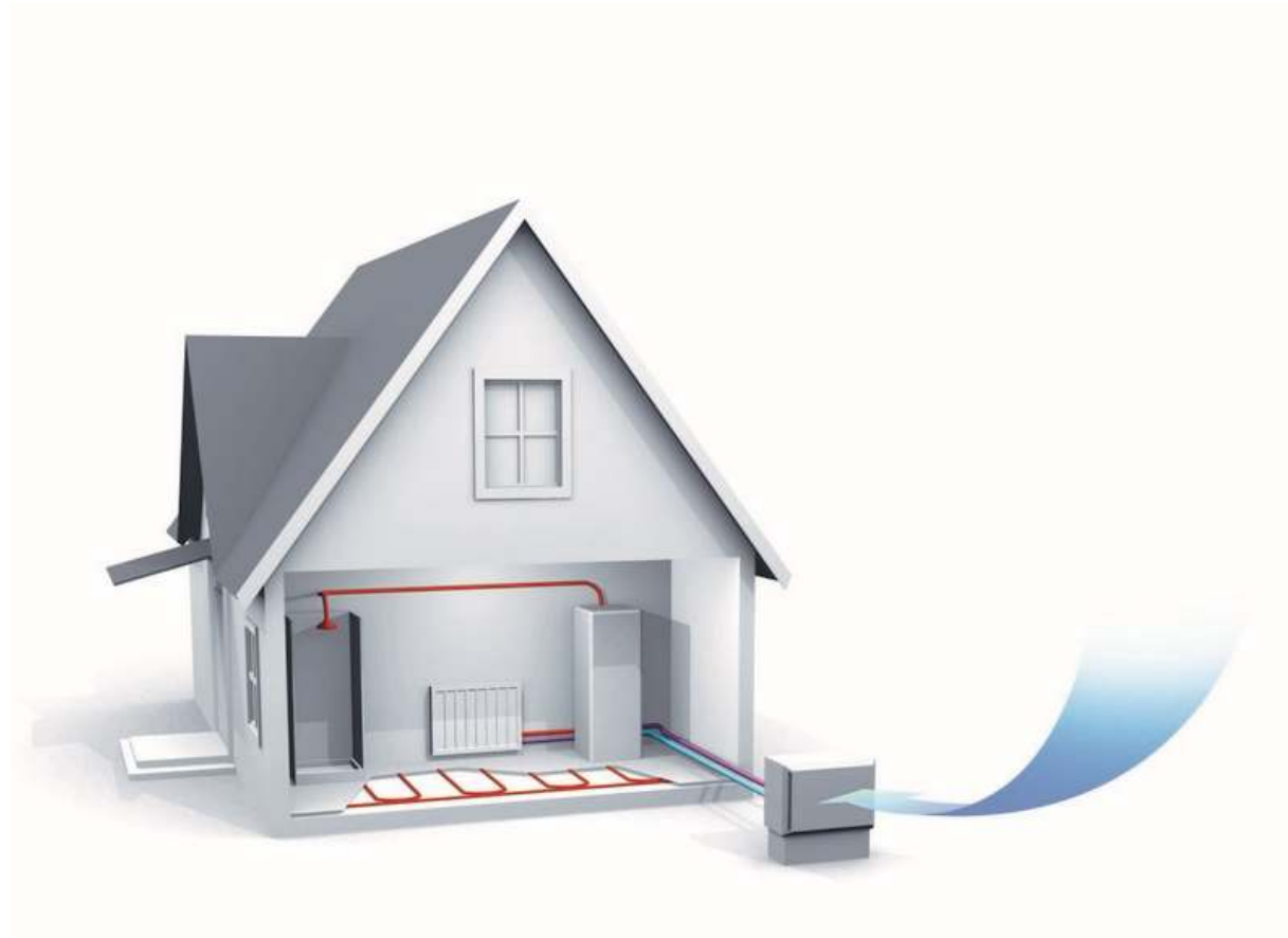
Slika 9. Primjer dizalice topline na zrak
