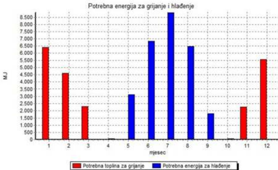
Grafikon 1. Potrebna energija za grijanje i hlađenje objekta
