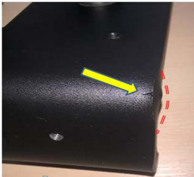
Slika 20. Prikaz loma materijala pri savijanju
