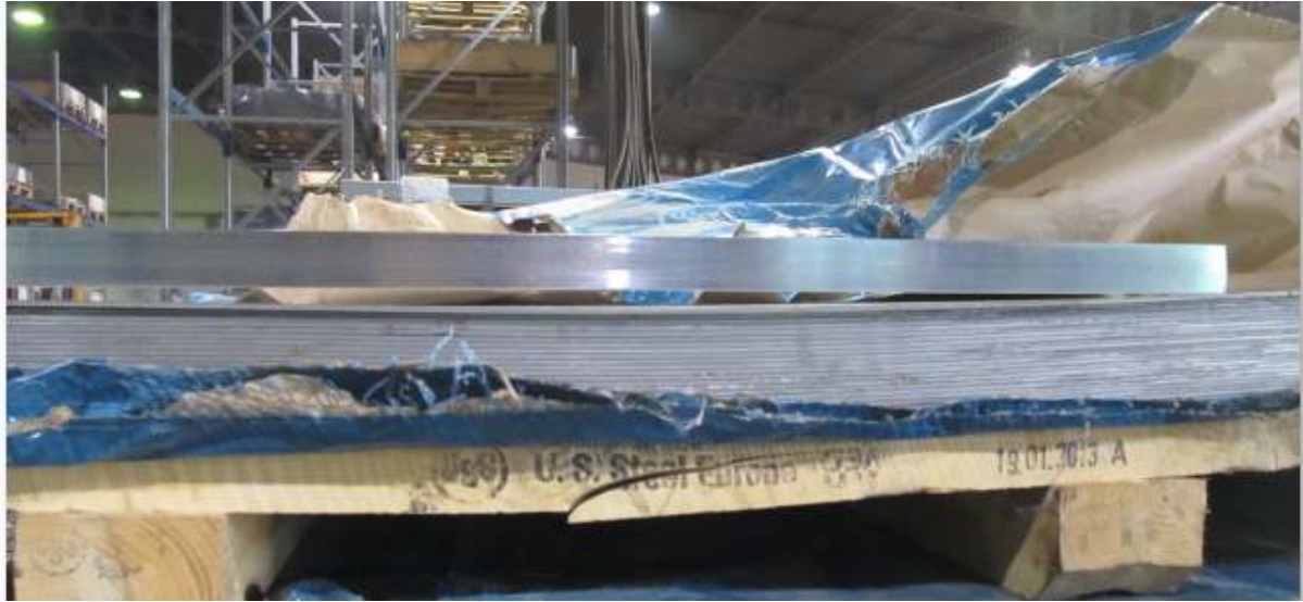
Slika 52. Lim isporučen sa greškom oblika
