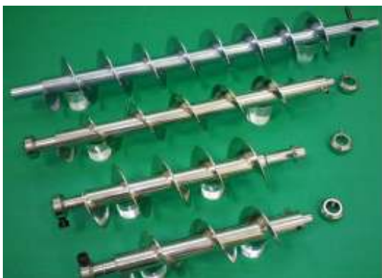
Slika 27. Pužni prijenosnici peleta
