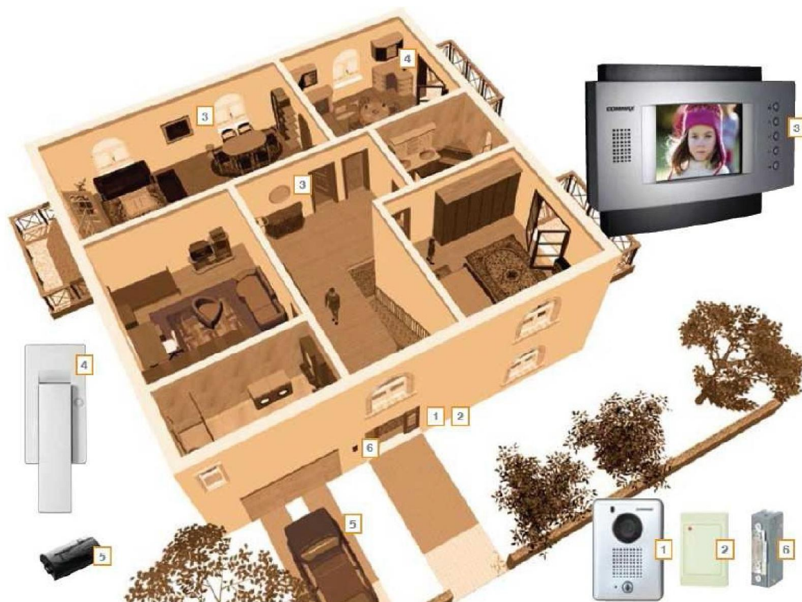
Slika 8-1 Sustav kontrole pristupa za stambeni objekt Oznake: 1-vanjska video parlafonska jedinica, 2-čitač, 3-unutrašnja video-parlafonska jedinica, 4-parlafonska slušalica, 5-daljinski upravljač za garažna vrata, 6-elektroprihvatnik
