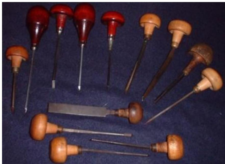
Slika 1: Asortiman ručnog alata za graviranje
