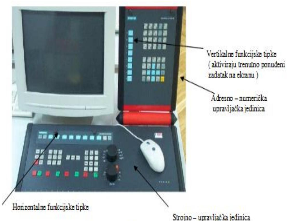
Slika 20: Upravljačka jedinica CNC stroja
