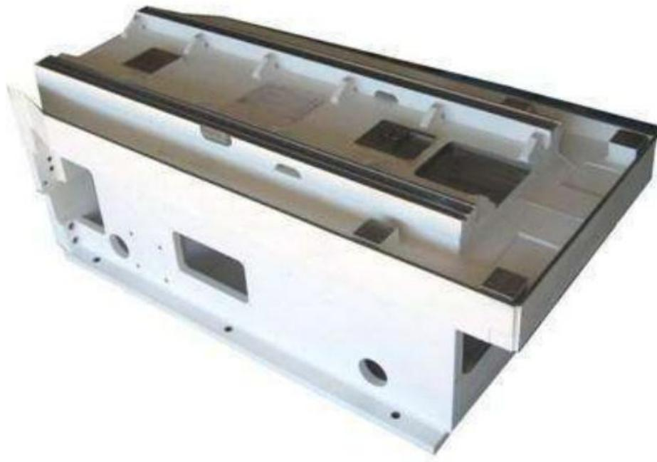
Slika 10: Zavarena izvedba postolja stroja
