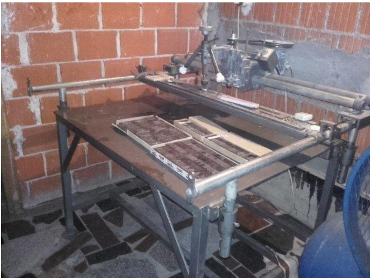
Slika 4: Ručni stroj za graviranje
