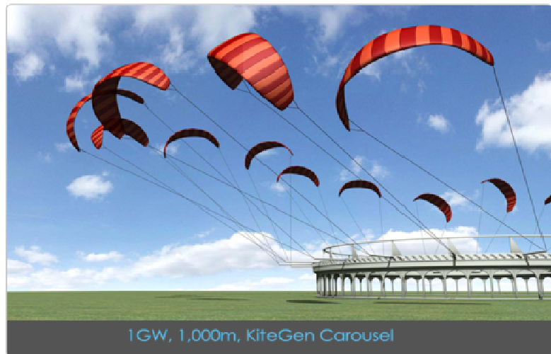
Slika 16: Vjetroagregat s nekoliko Kiteova
