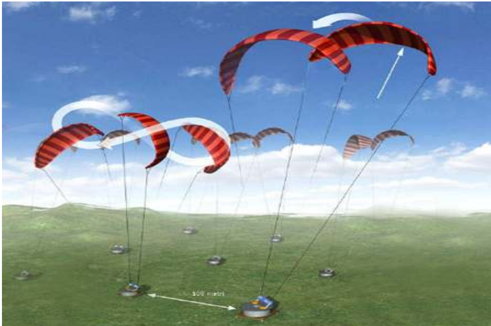
Slika 19: KiteGen za kopnene i morske vjetroelektrane
