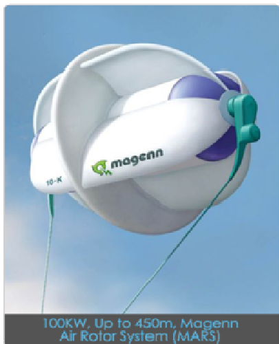
Slika 16: Vjetroagregat s nekoliko Kiteova
