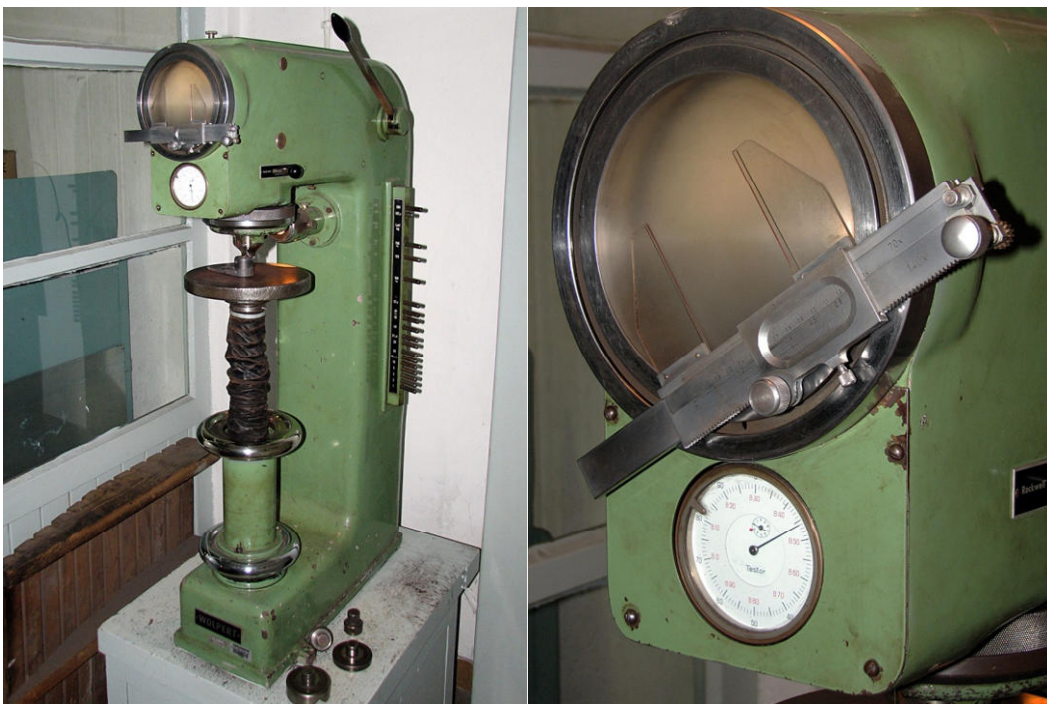
Slika 38. Uređaj za mjerenje tvrdoće Wolpert
