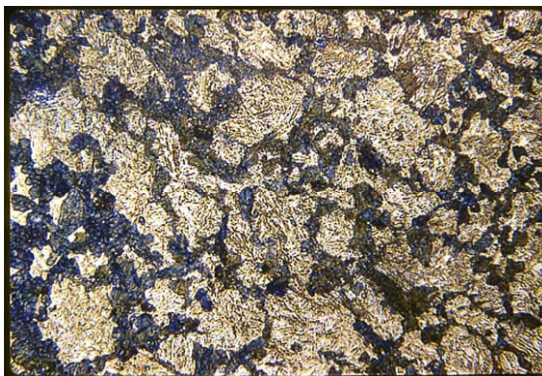
Slika 43. Metalografski snimak podpovršinskog – prijelaznog sloja
