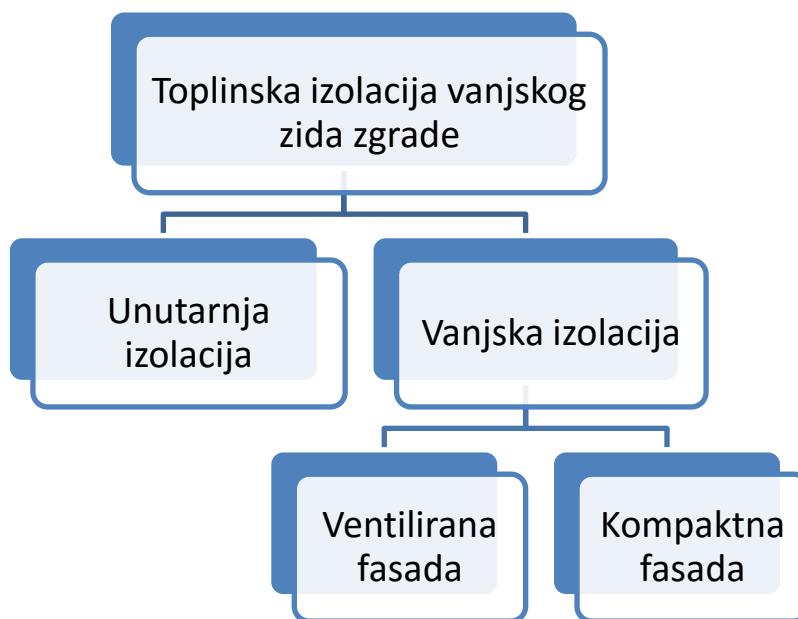
Grafikon 1. Toplinska izolacija vanjskog zida zgrade
