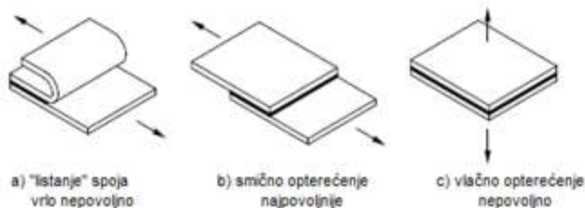
Slika 3.: Povoljno i nepovoljno zalijepljene komponente
