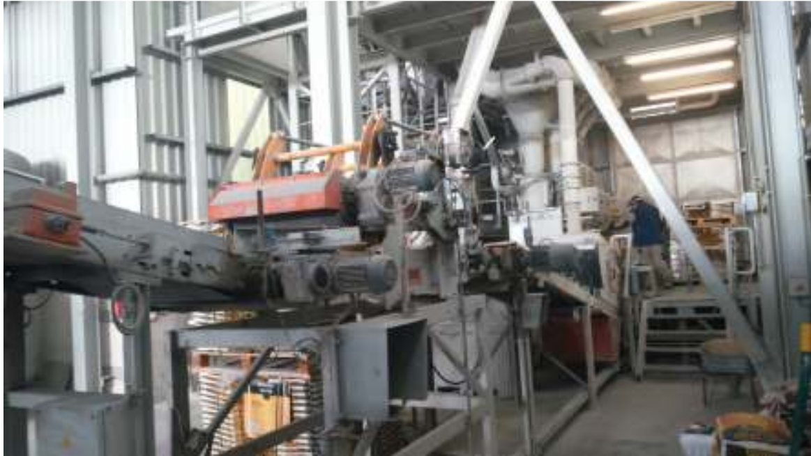
Slika 25.: Trakasti transporter vodi u sustav za paletiziranje
