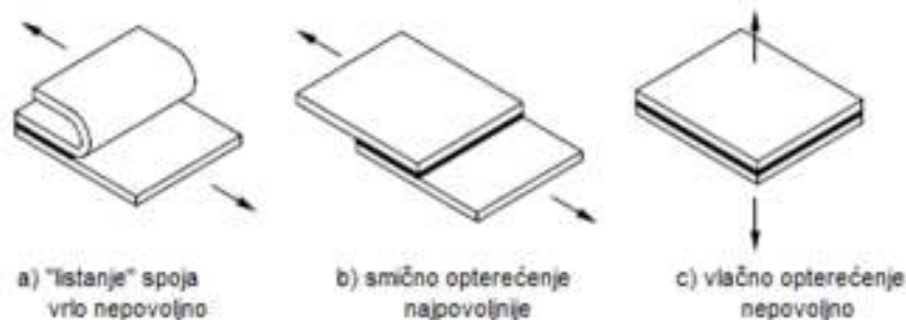
Slika 3.: Povoljno i nepovoljno zalijepljene komponente
