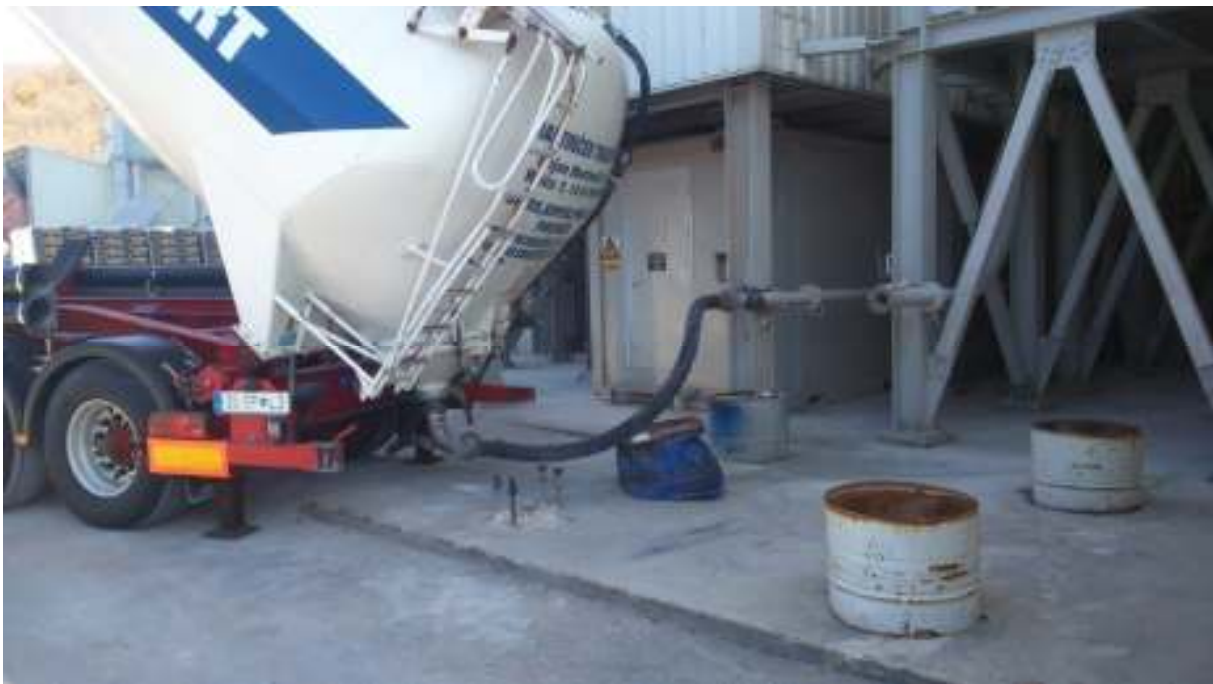
Slika 12.: Dopremanje veziva auto cisternom
