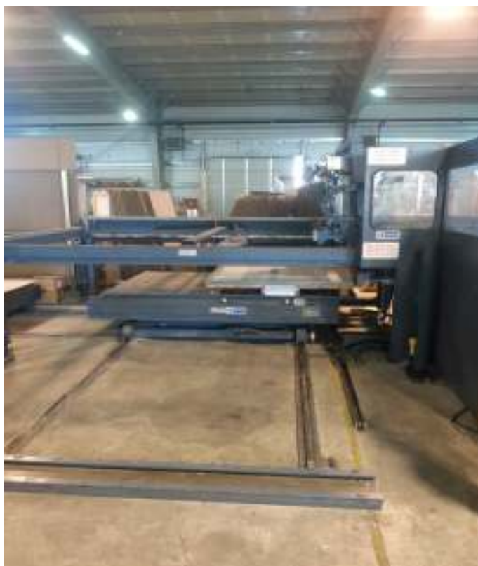
Slika 15: Štanca CNC(ulazni stol); Izvor:Interne slike poduzeća Fusio d.o.o.
