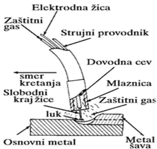
Slika 20: Elektrolučno zavarivanje topljivom elektronom u zaštiti plina
