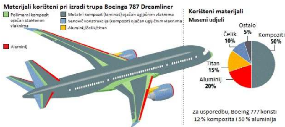
Slika 18. Kompozitna struktura Boeinga 787 Dreamliner
