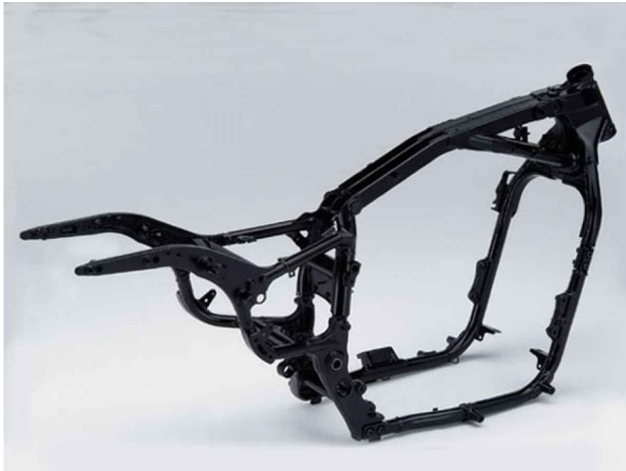
Slika 21 Okvir s dvostrukim nosačima
