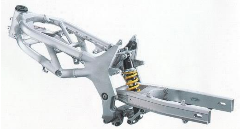
Slika 23 Rešetkasti okvir sa stražnjim ovjesom
