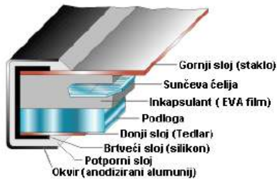
Slika 16.: Poprečni presjek fotonaponskog modula sačinjenog od kristalnog silicija
